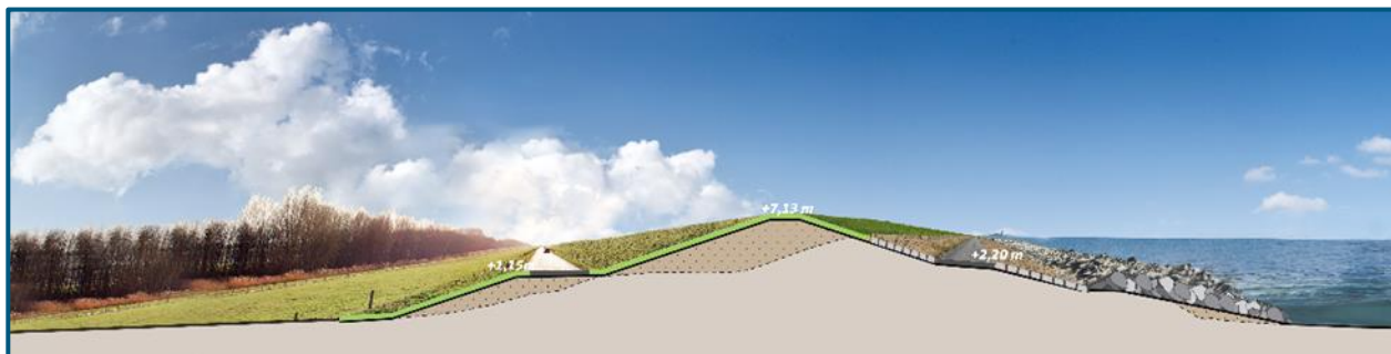
Figuur 2-3 Visualisatie van de binnendijkse versterking in dijkvak 2 ter hoogte van Flevokust en Maximacentrale.
