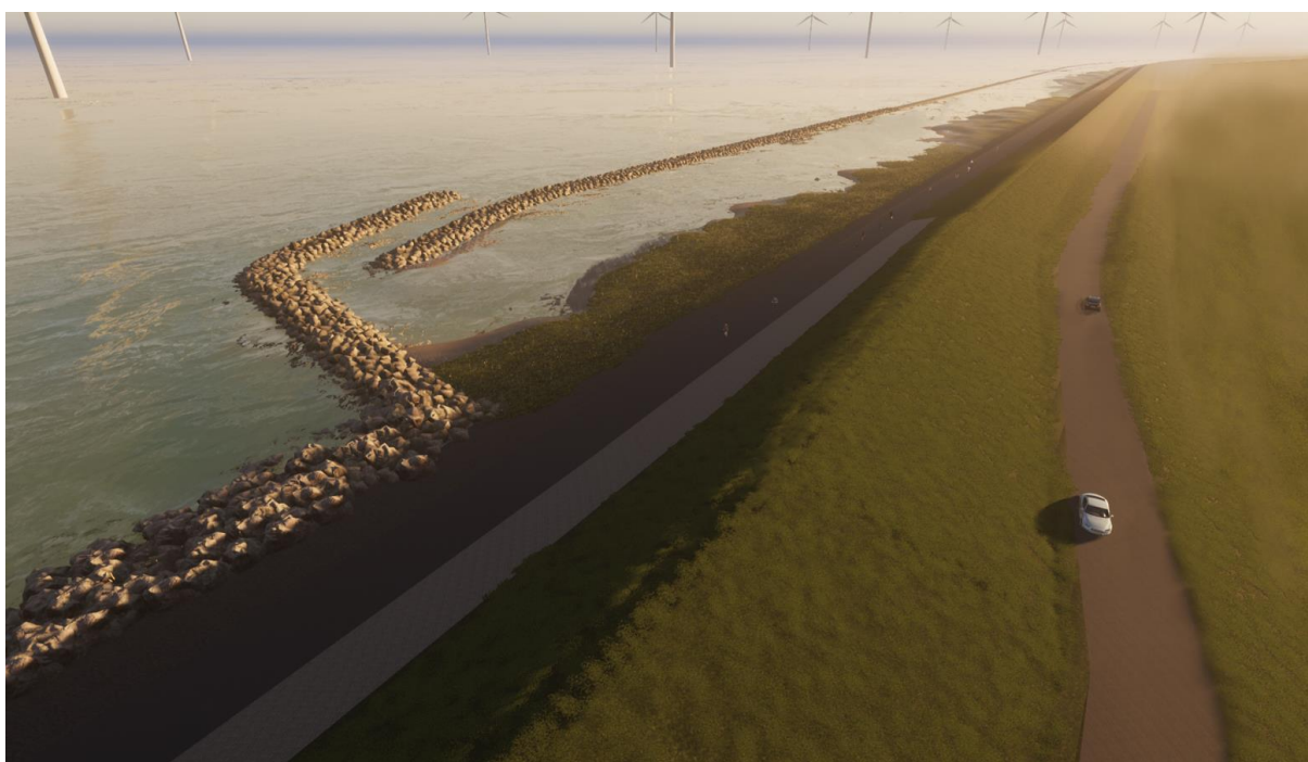
Figuur 7-6: Visualisatie van de overgang tussen de Vooroever naar een alternatief met een traditionele versterking.
