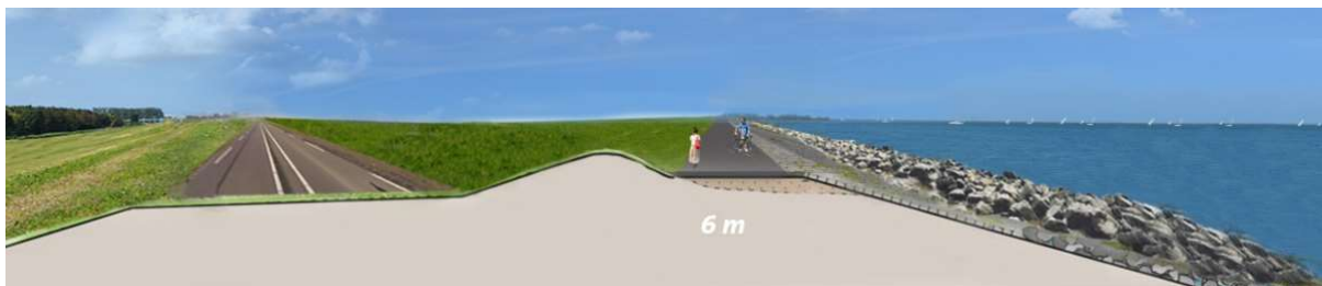
Figuur 2-6: Fotovisualisatie aanpassingen dijkvak 4 (versterken teen, zetsteen buitentalud vervangen, verhogen buitenberm/ zetsteen, nieuwe berm met asfalt)
