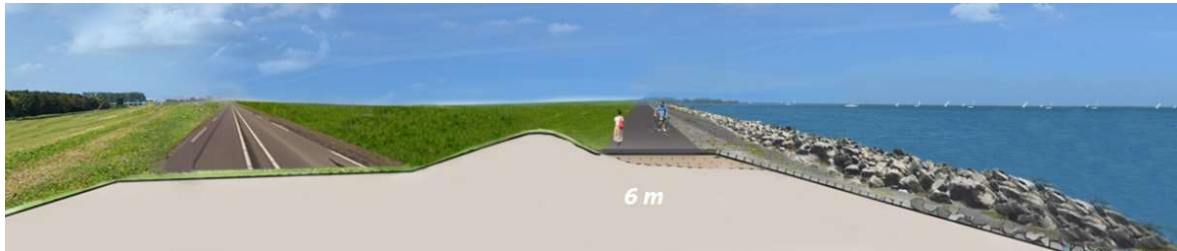
Figuur 4-3: Fotovisualisatie van de versterking voor traject Baaidijk (versterken zetsteen, teenversterking, verhoging buitenberm, nieuw asfalt aanbrengen)
