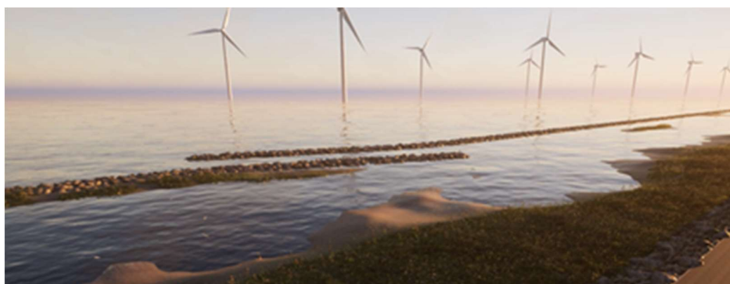
Figuur 0-1: Impressie van de vooroever (beperkte ecologische inrichting) met verspringende langsdammen bij openingen
