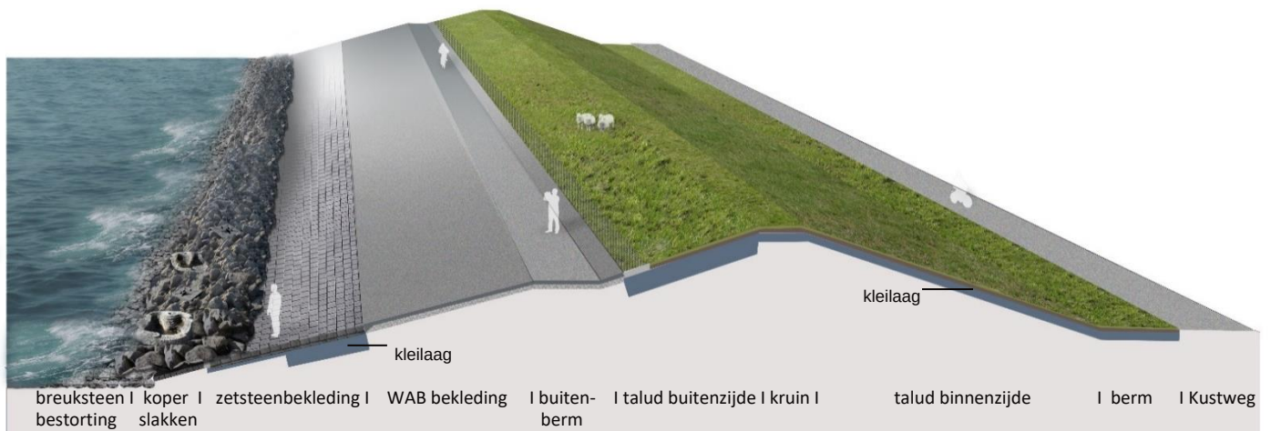
Figuur 12-3 Ontwerp landelijke dijk met steenbestorting op ware schaal
