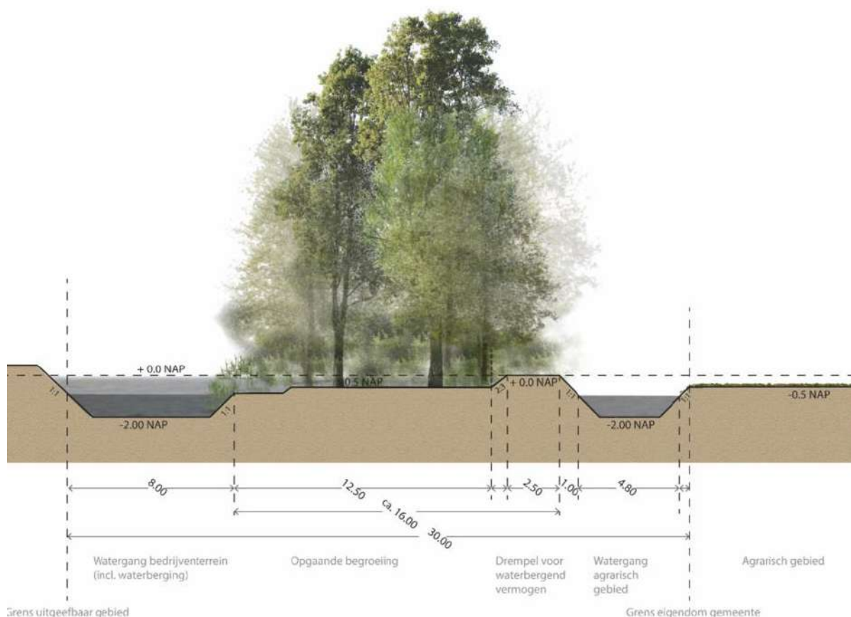
Afbeelding 5: watersysteem aan de oostkant (t.p.v. VEBE)
