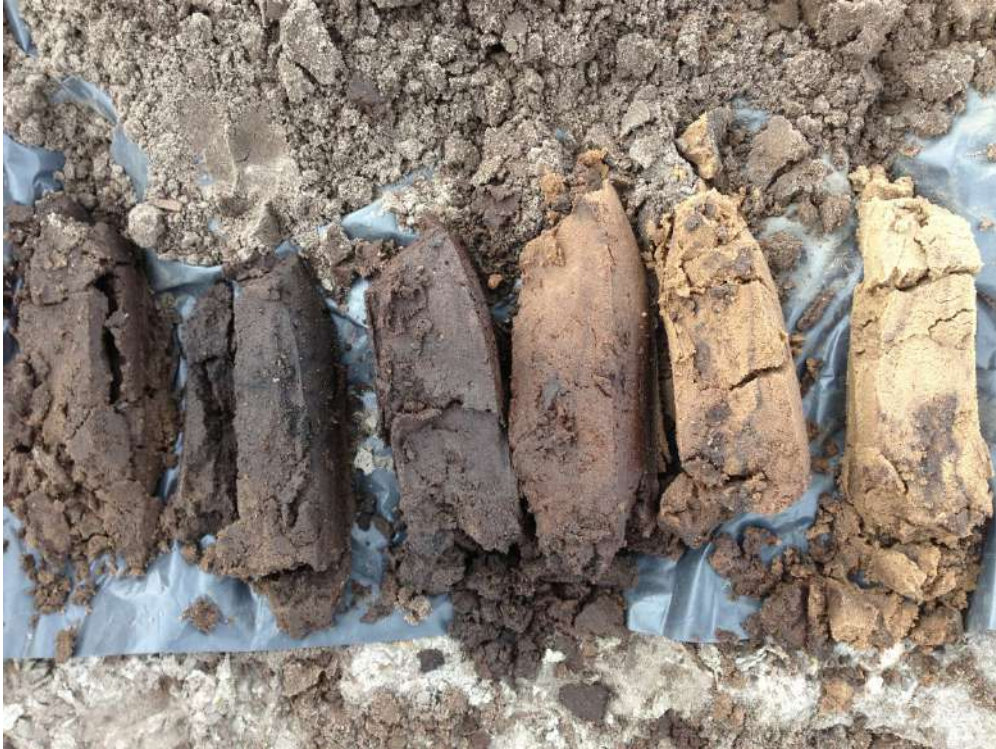
Afbeelding 21: Boring 38, detailopname podzol in top dekzand (mogelijk verspoeld dekzand / overgangszone beekdal).
