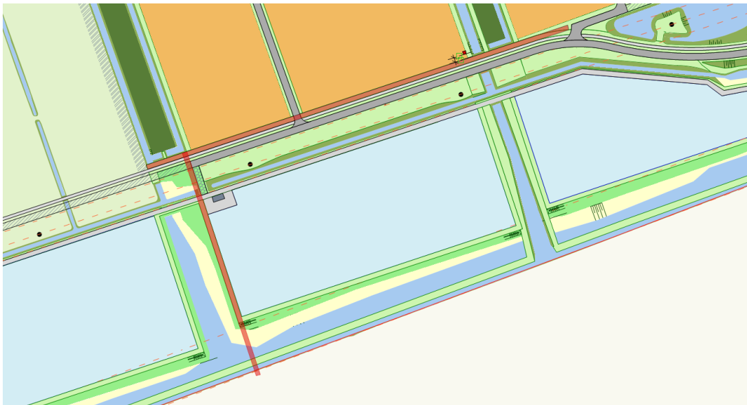
Figuur 4.3 | indicatie mogelijk kabeltracé (rood)
