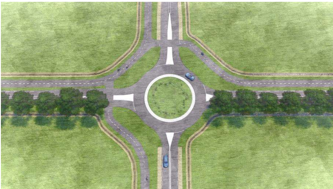
Figuur 24 Bovenaanzicht van een schetsimpressie van het mitigeren van een doorsnijding van historische wegstructuur: bomen worden zo dicht als mogelijk tot aan de rotonde geplant.
