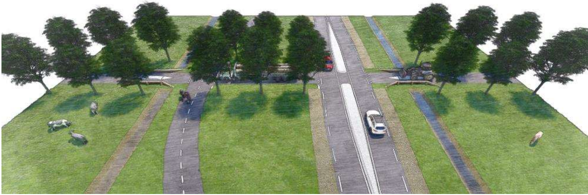
Figuur 27 Vogelvlucht van een schetsimpressie van de koude oversteek met een smalle middenberm en meer ruimte tussen de parallelweg en de rondweg. Hierdoor is het voor landbouwverkeer veiliger om de rondweg te passeren. (Dit is een schetsimpressie. De precieze hoogteligging, inrichting en dimensionering worden na vaststelling VKA uitgewerkt.)
