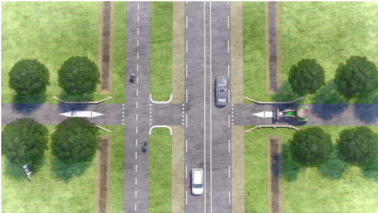
Figuur 26 Bovenaanzicht van een schetsimpressie van de koude oversteek en het mitigeren van een doorsnijding van historische wegstructuur: bomen langs de Barnseweg worden zo dicht als mogelijk tot aan de rondweg geplant. (Dit is een schetsimpressie. De precieze hoogteligging, inrichting en dimensionering worden na vaststelling VKA uitgewerkt.)
