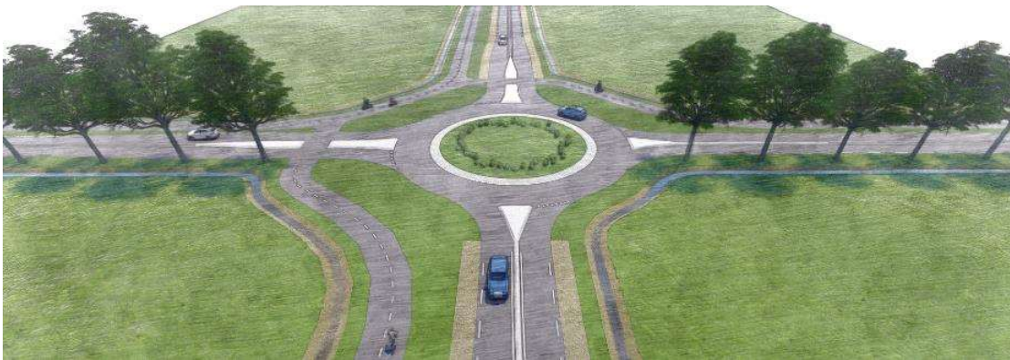
Figuur 23 Vogelvlucht van een schetsimpressie van het mitigeren van een doorsnijding van historische wegstructuur: bomen worden zo dicht als mogelijk tot aan de rotonde geplant.
