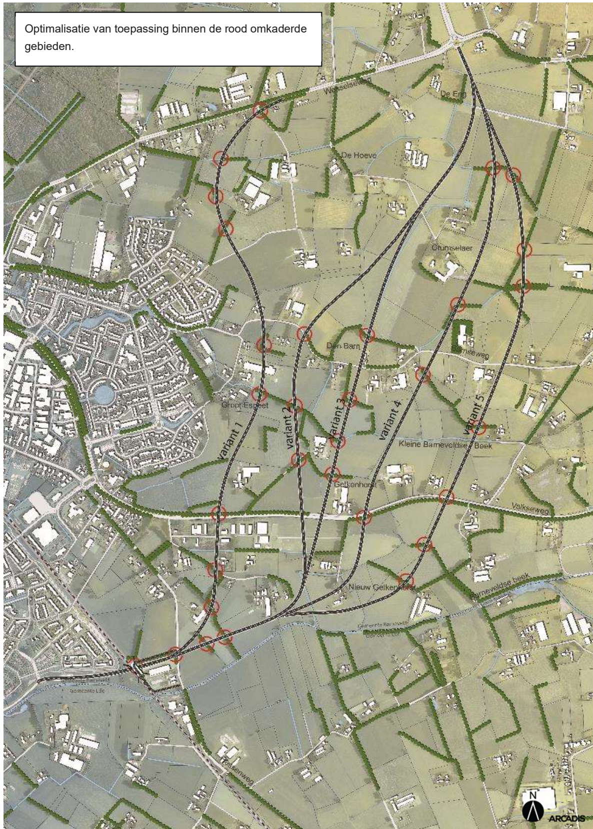
Figuur 18 Doorsnijding boomsingels tracévarianten met onderdoorgang spoor
