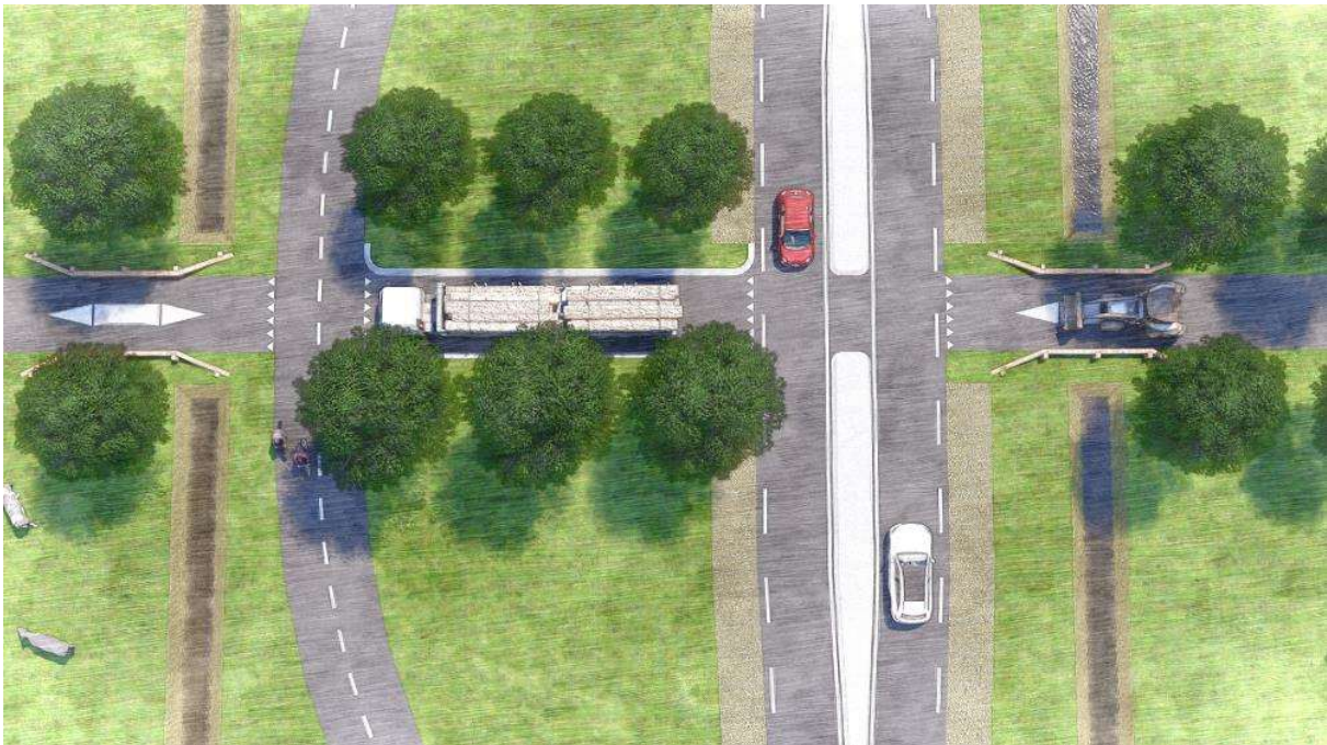
Figuur 28 Vogelvlucht van een schetsimpressie van de koude oversteek met een smalle middenberm en meer ruimte tussen de parallelweg en de rondweg. Hierdoor is het voor landbouwverkeer veiliger om de rondweg te passeren. (Dit is een schetsimpressie. De precieze hoogteligging, inrichting en dimensionering worden na vaststelling VKA uitgewerkt.)
