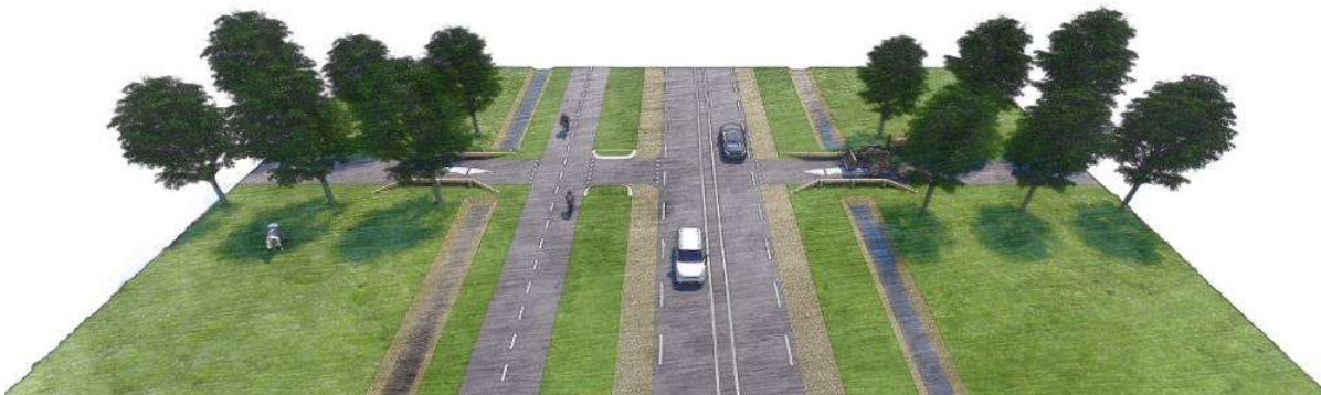
Figuur 25 Vogelvlucht van een schetsimpressie van de koude oversteek het mitigeren van een doorsnijding van historische wegstructuur: bomen langs de Barnseweg worden zo dicht als mogelijk tot aan de rondweg geplant. (Dit is een schetsimpressie. De precieze hoogteligging, inrichting en dimensionering worden na vaststelling VKA uitgewerkt.)
