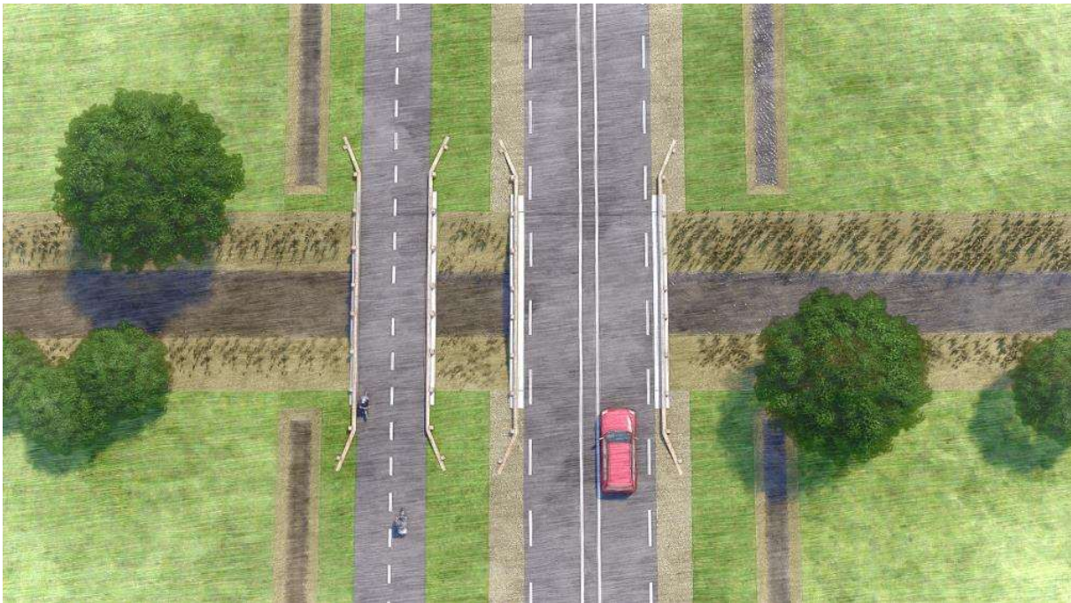
Figuur 34 Bovenaanzicht van een schetsimpressie van de 'zwevende' overkluizing van de beek. (Dit is een schetsimpressie. De precieze hoogteligging, inrichting en dimensionering van de bruggen wordt na vaststelling VKA uitgewerkt.)
