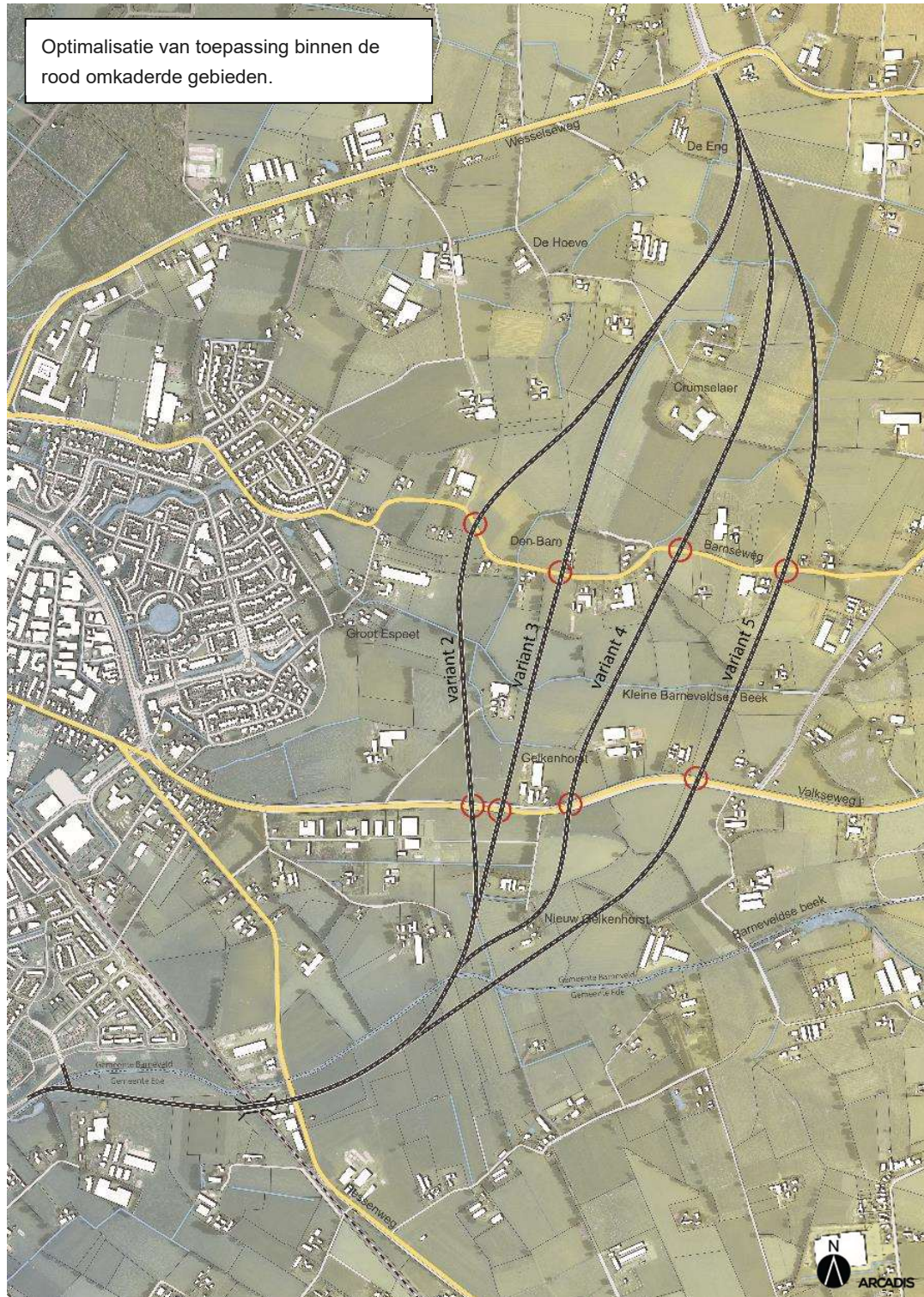
Figuur 21 Doorsnijding historische structuren varianten viaduct
