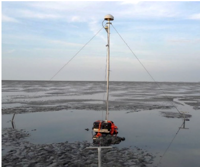
Figuur 7: Meetopstelling jaarlijkse GNSS monitoring
