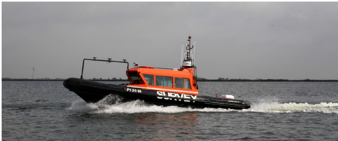
Figuur 2-1 Foto van het soort meetvaartuig dat door de surveyor (Deep B.V.) wordt ingezet voor het uitvoeren van de hoogte/dieptemetingen.
