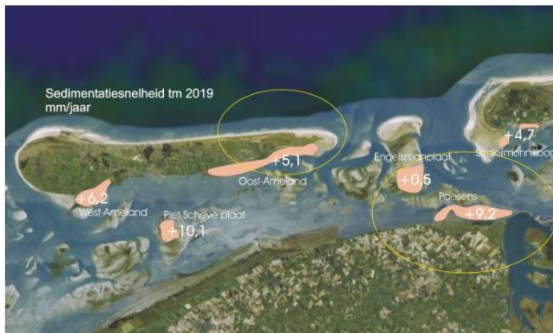
Figuur 4.6 Sedimentatiesnelheid per onderzoeksgebied in mm/jaar. De reeksen waarop het gemiddelde is gebaseerd variëren in lengte van 5 tot 18 jaar, maar ze zijn allemaal bijgewerkt tot en met 2019. Overgenomen uit Krol (2020)
