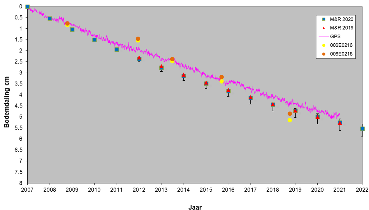
Figuur 2-13; Voorspelde en gemeten bodemdaling (GNSS) op de GNSS-locatie Anjum (coördinaten: X-RD: 205931.145, Y-RD: 598546.039). De onzekerheidsbandbreedte wordt gegeven door de bodemdalingberekeningen volgens het hoge en lage scenario. De voorspelde bodemdaling op basis van de Meet- en regelcyclus rapportage over 2019 is aangegeven in rood. In oranje en geel is de gemeten bodemdaling op peilmerk 006G0216 en 006G0218 (dicht bij het GNSS-punt) middels waterpassing aangegeven.
