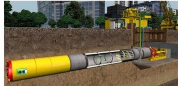
Figuur B18 - Microtunnel installatie
