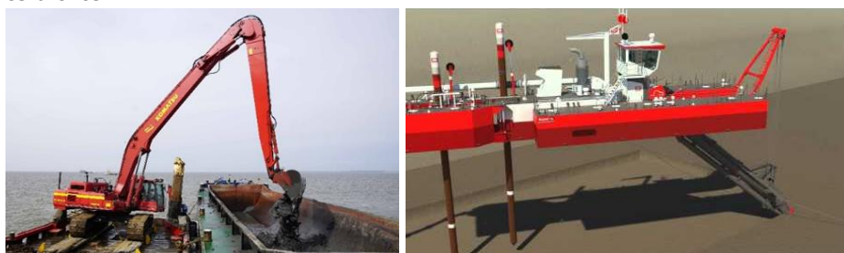
Figuur B5 – Links: Baggeren met graafmachine Rechts: Snijkopzuiger
