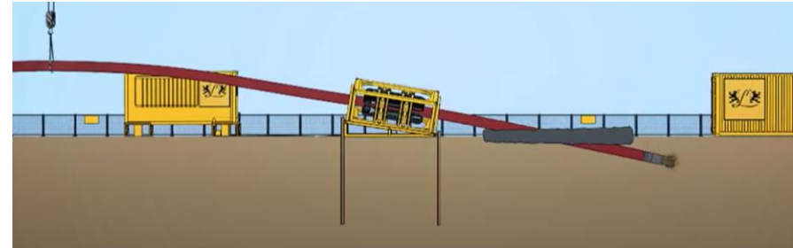
Figuur B21 - Van Leeuwen Sleufloze Technieken: direct drill techniek
