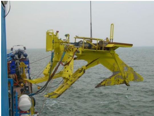
Figuur B14 - Een ploeg voor kabels en kleine leidingen
