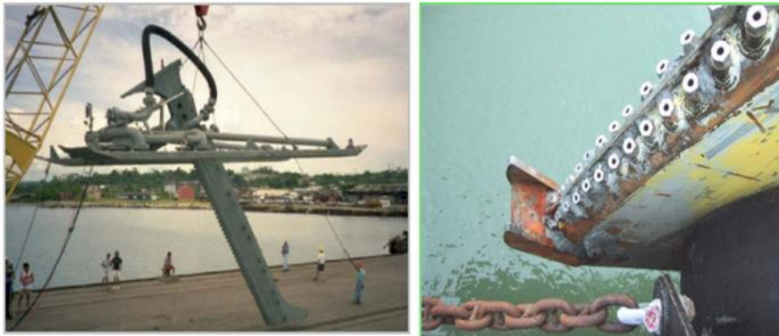
Figuur B9 - Jet-injector op slede (links) en spuitkoppen op de lans (rechts)
