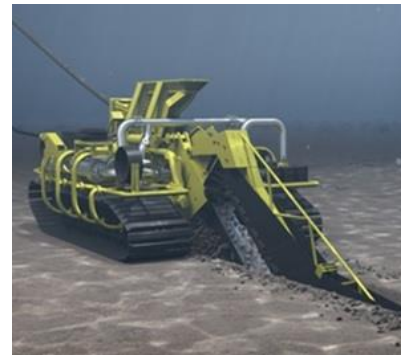
Figuur B 13 - links een sleuvengraver voor het leggen van pijpleidingen, rechts een sleuvengraver op het dek van een schip
