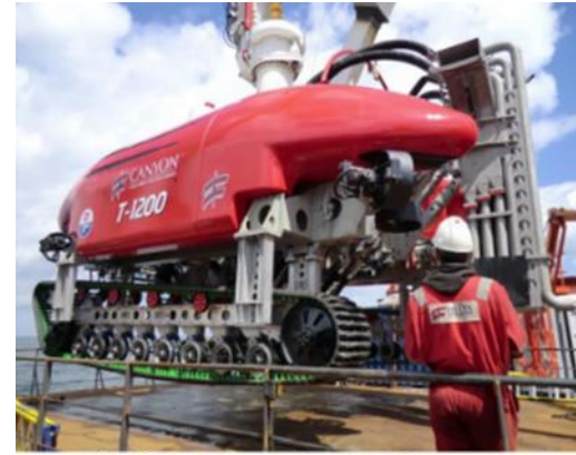
Figuur B15 - Jetting trencher (links) en jetting zwaard (rechts)
