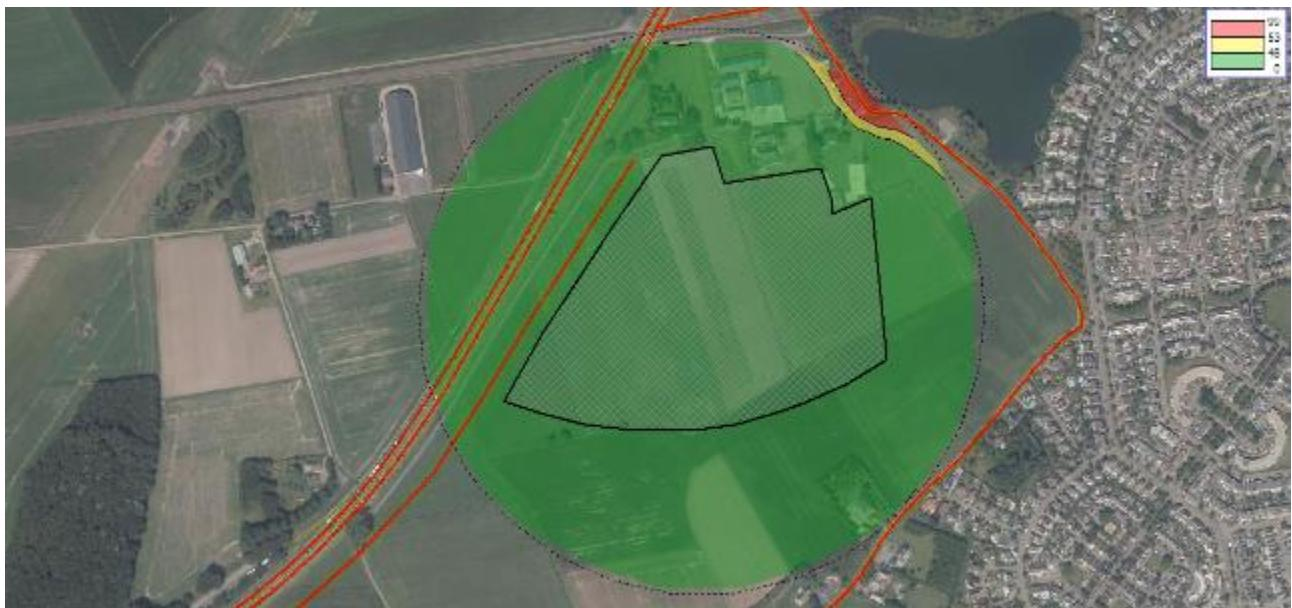
Figuur 10 Geluidcontouren Bulkenaarsestraat/Huijbergseweg (contouren op 1,5 m boven maaiveld)
