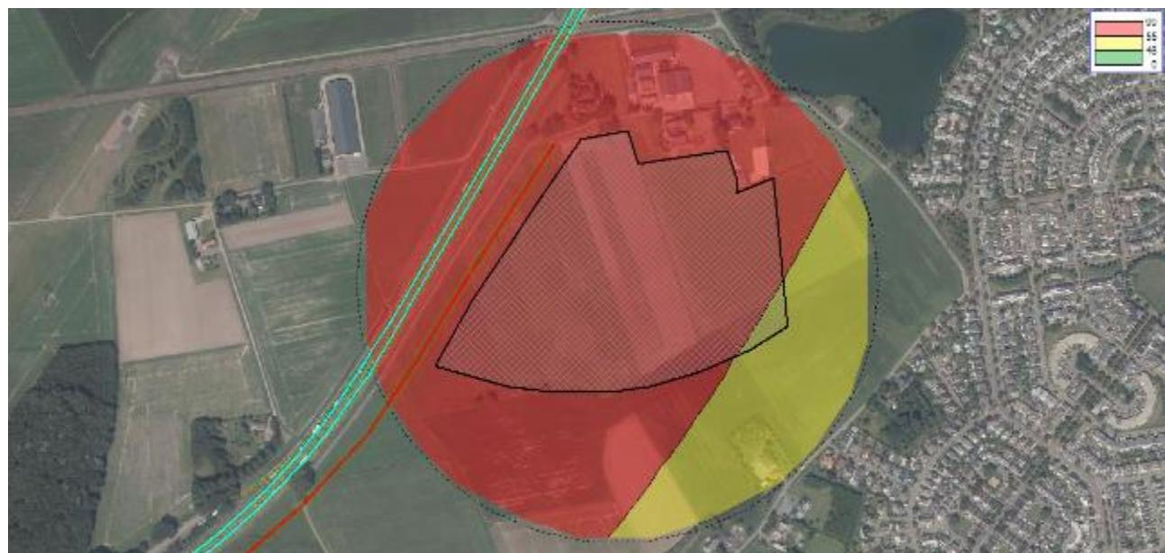
Figuur 19 Geluidcontouren A58 (contouren op 10 m boven maaiveld)
