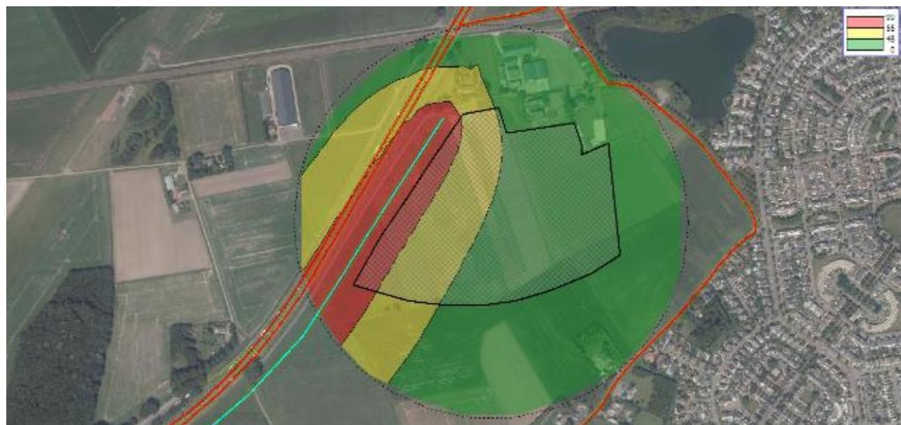
Figuur 6 Geluidcontouren verbindingsweg (contouren op 15 m boven maaiveld)
