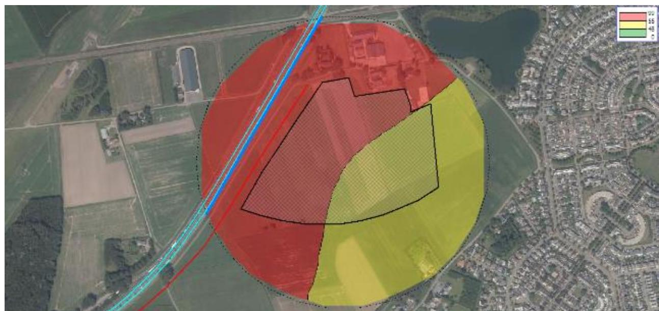
Figuur 35 Geluidcontouren A58 met geluidscherms 3m hoog en 570 m lang (contouren op 20 m boven maaiveld)
