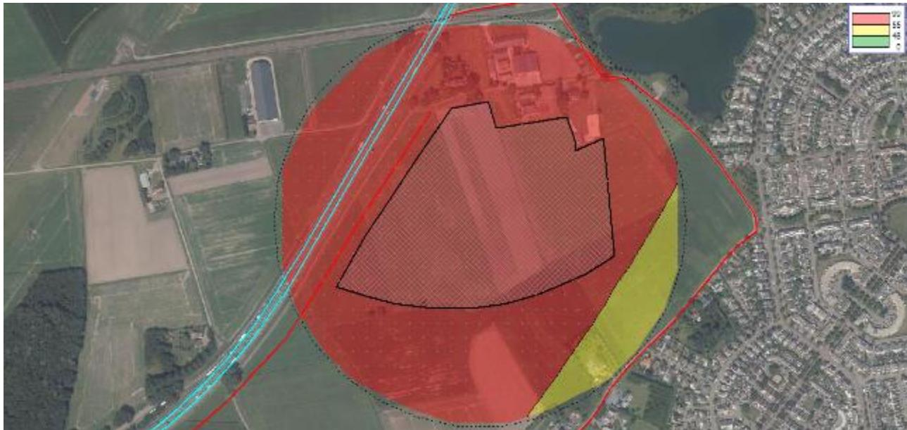
Figuur 23 Geluidcontouren A58 (contouren op 30 m boven maaiveld)
