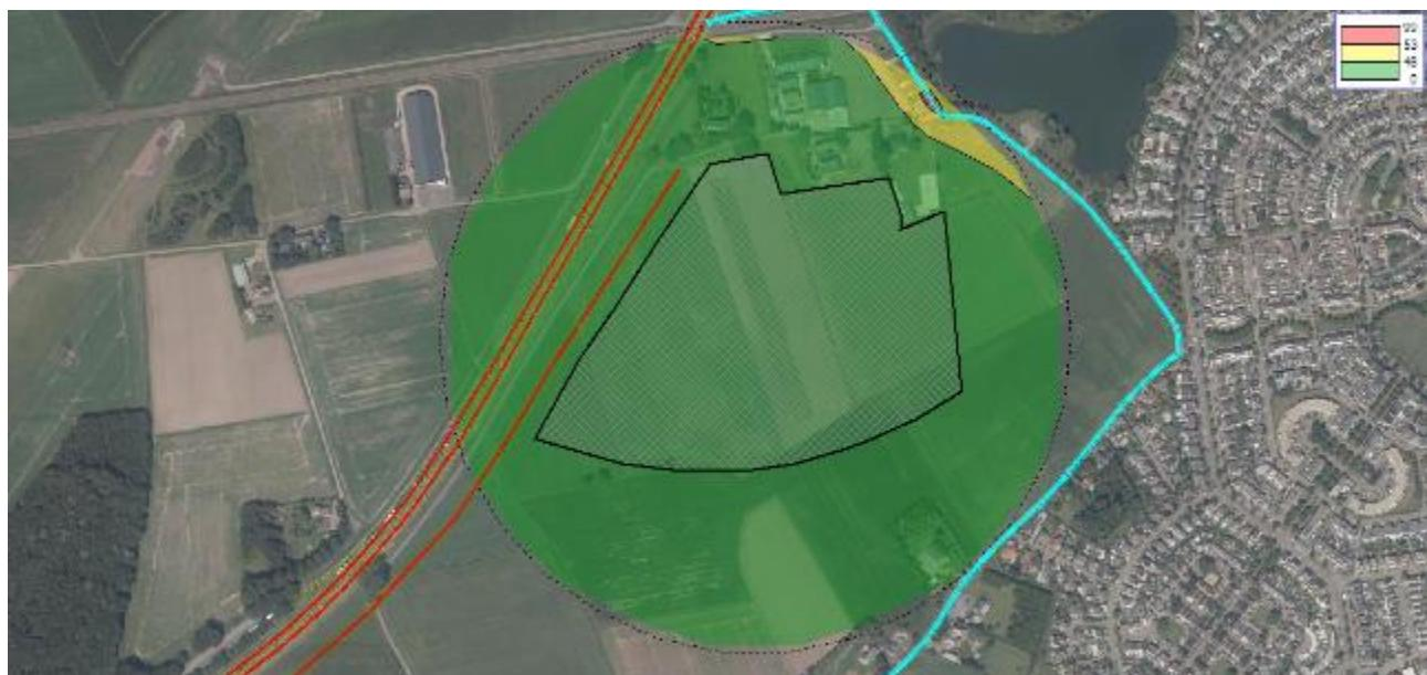
Figuur 14 Geluidcontouren Bulknaarsestraat/Huijbergseweg (contouren op 20 m boven maaiveld)
