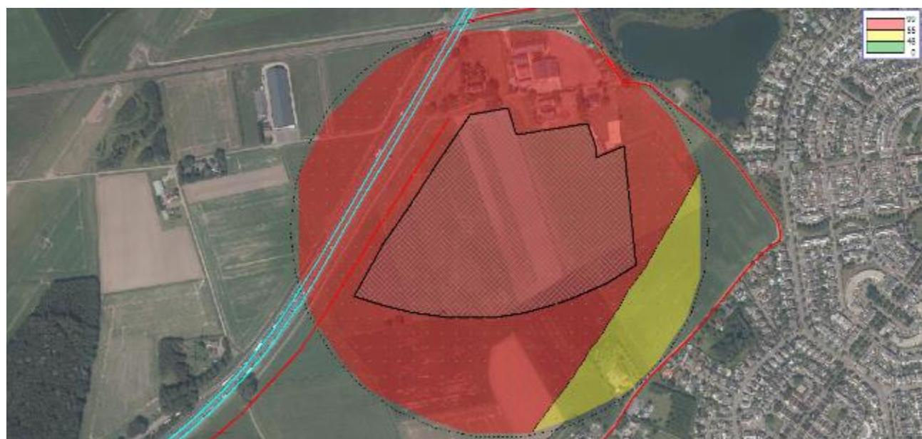
Figuur 22 Geluidcontouren A58 (contouren op 25 m boven maaiveld)
