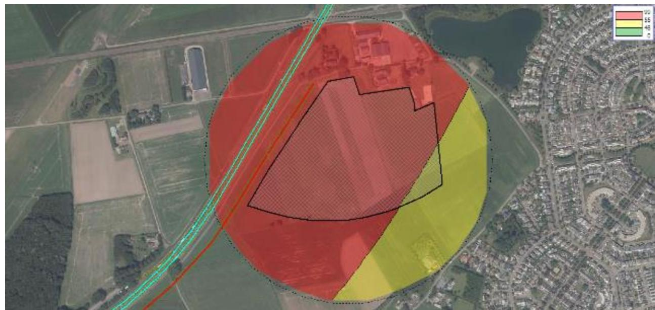
Figuur 18 Geluidcontouren A58 (contouren op 5 m boven maaiveld)
