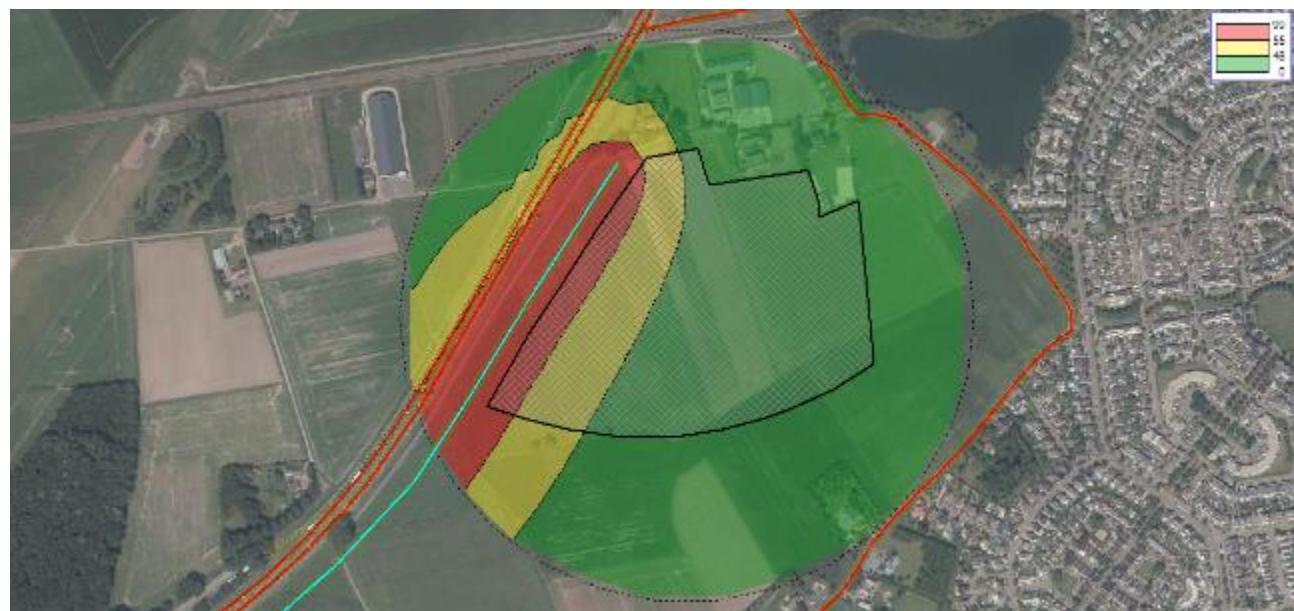
Figuur 4 Geluidcontouren verbindingsweg (contouren op 5 m boven maaiveld)
