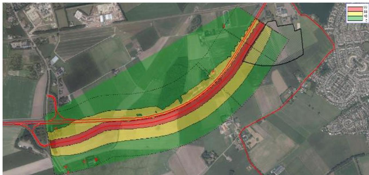
Figuur 46 Geluidcontouren verbindingsweg (contouren op 1,5 m boven maaiveld)
