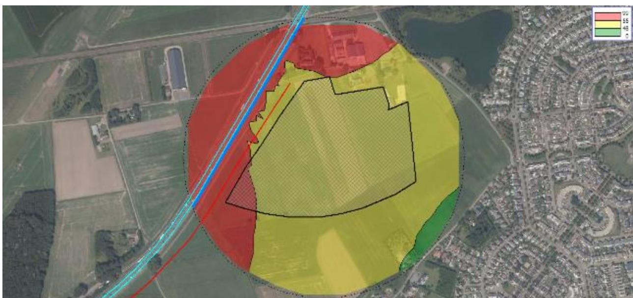
Figuur 31 Geluidcontouren A58 met geluidscherm 3m hoog en 570 m lang (contouren op 1,5 m boven maaiveld)
