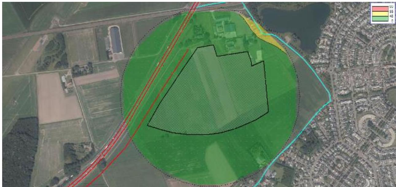
Figuur 16 Geluidcontouren Bulknaarsestraat/Huijbergseweg (contouren op 30 m boven maaiveld)
