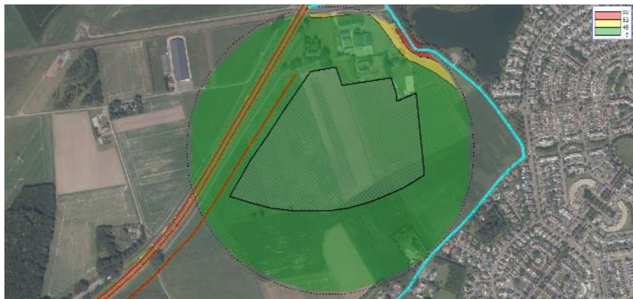
Figuur 12 Geluidcontouren Bulknaarsestraat/Huijbergseweg (contouren op 10 m boven maaiveld)
