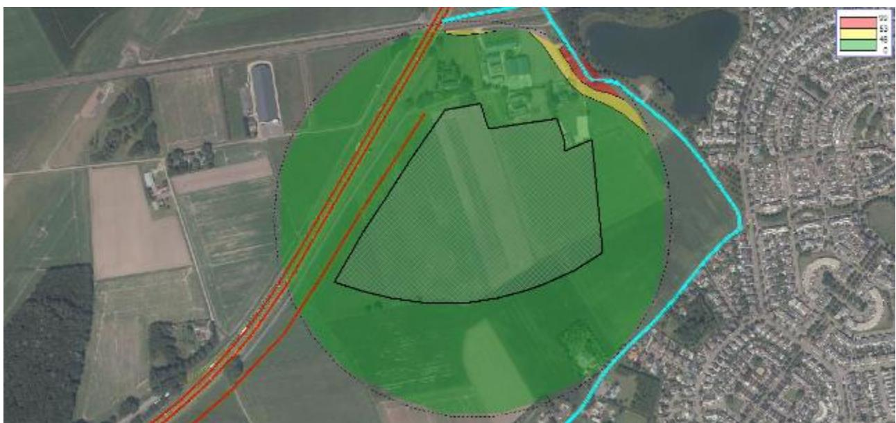
Figuur 11 Geluidcontouren Bulkenaarsestraat/Huijbergseweg (contouren op 5 m boven maaiveld)
