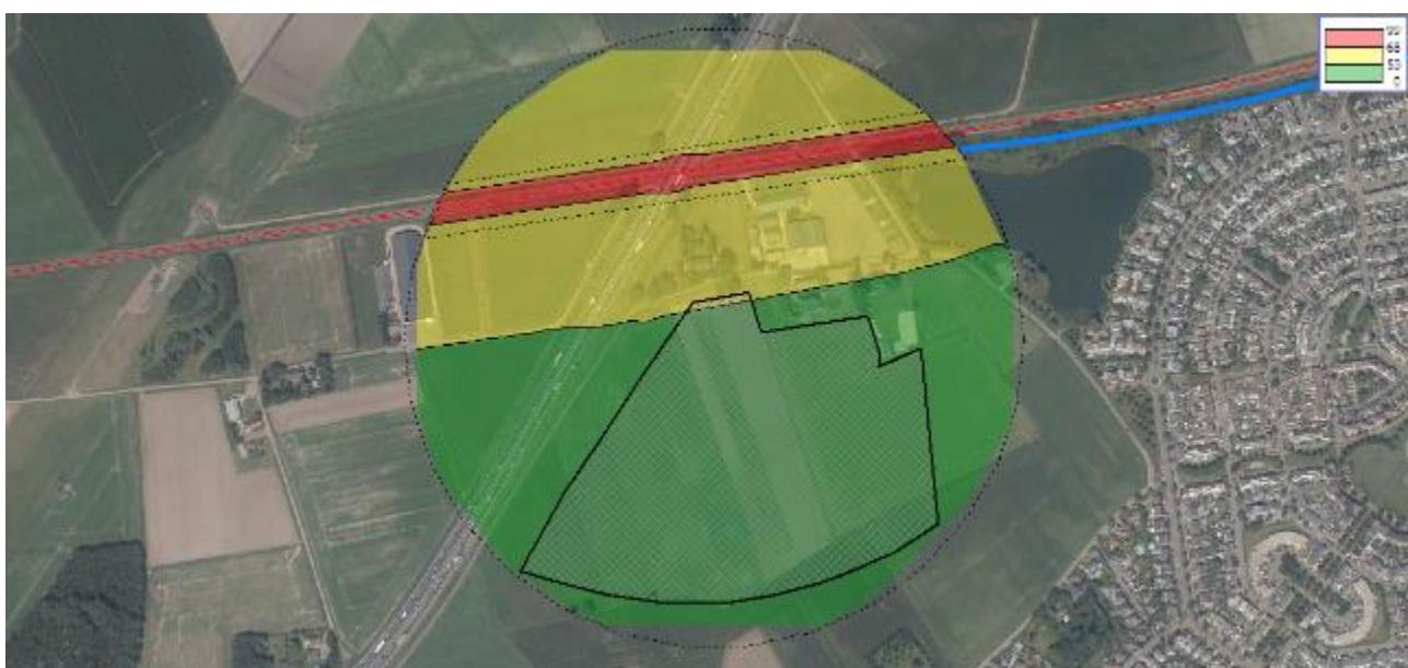
Figuur 40 Geluidcontouren spoorlijn Roosendaal – Bergen op Zoom (contouren op 5 m boven maaiveld)
