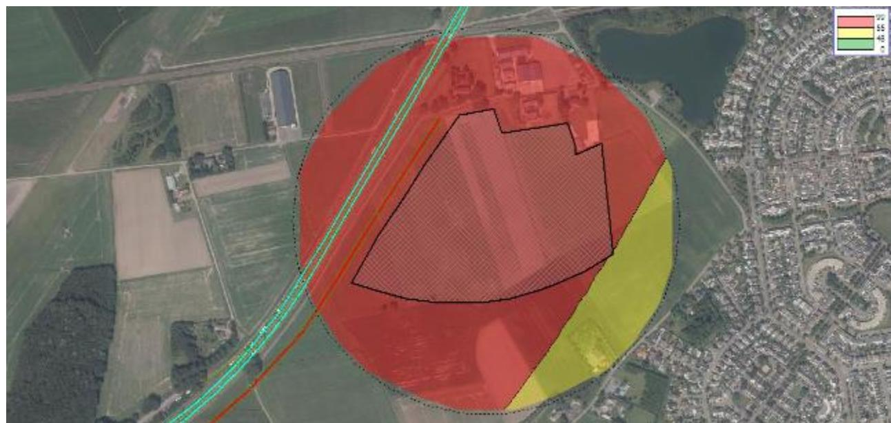
Figuur 21 Geluidcontouren A58 (contouren op 20 m boven maaiveld)
