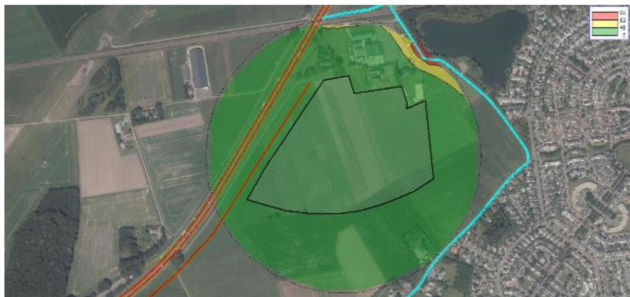
Figuur 13 Geluidcontouren Bulknaarsestraat/Huijbergseweg (contouren op 15 m boven maaiveld)
