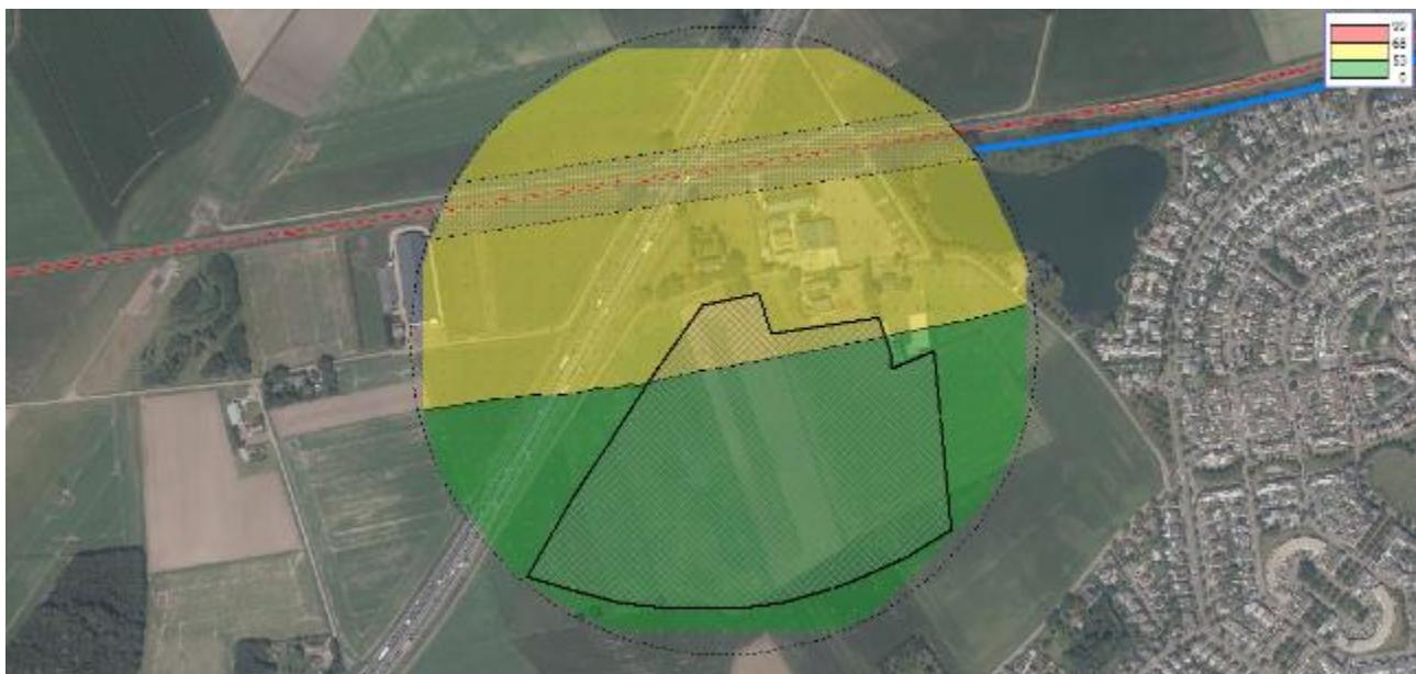
Figuur 44 Geluidcontouren spoorlijn Roosendaal – Bergen op Zoom (contouren op 25 m boven maaiveld)
