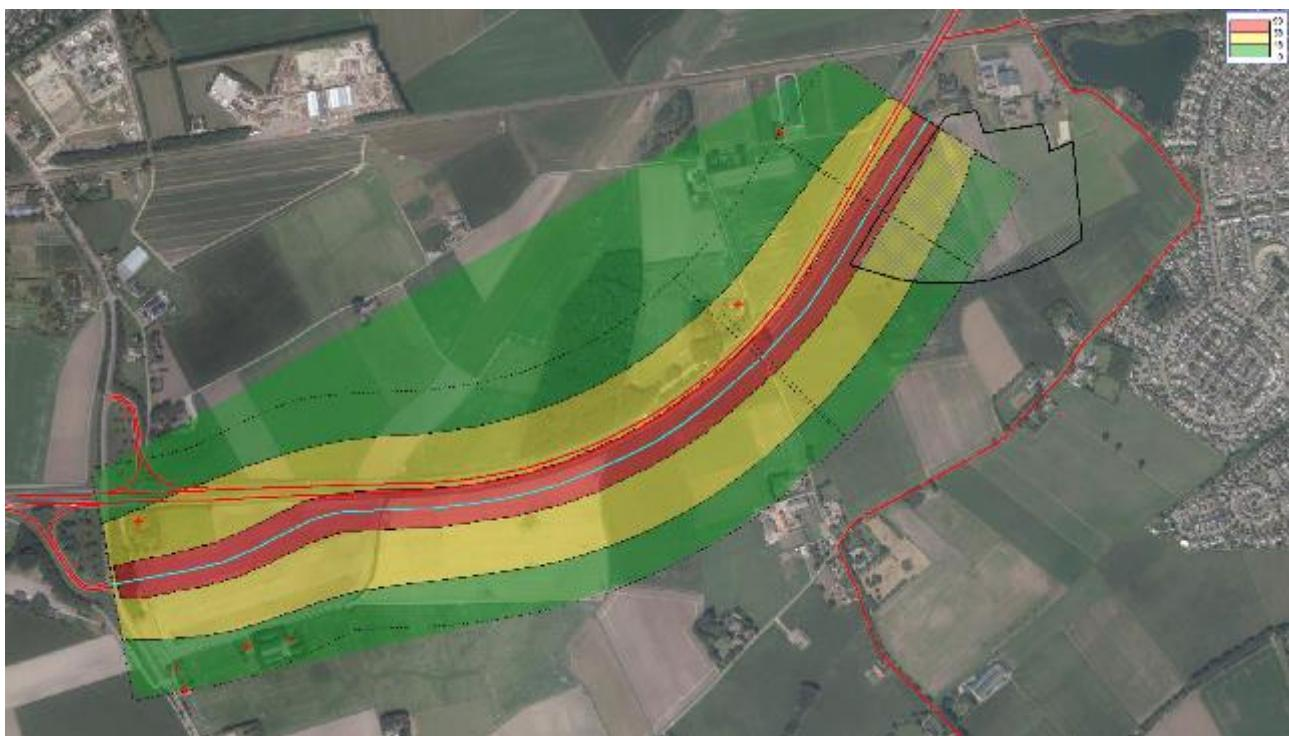
Figuur 48 Geluidcontouren verbindingsweg (contouren op 8 m boven maaiveld)
