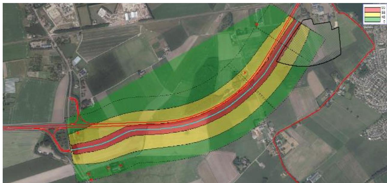
Figuur 47 Geluidcontouren verbindingsweg (contouren op 5 m boven maaiveld)
