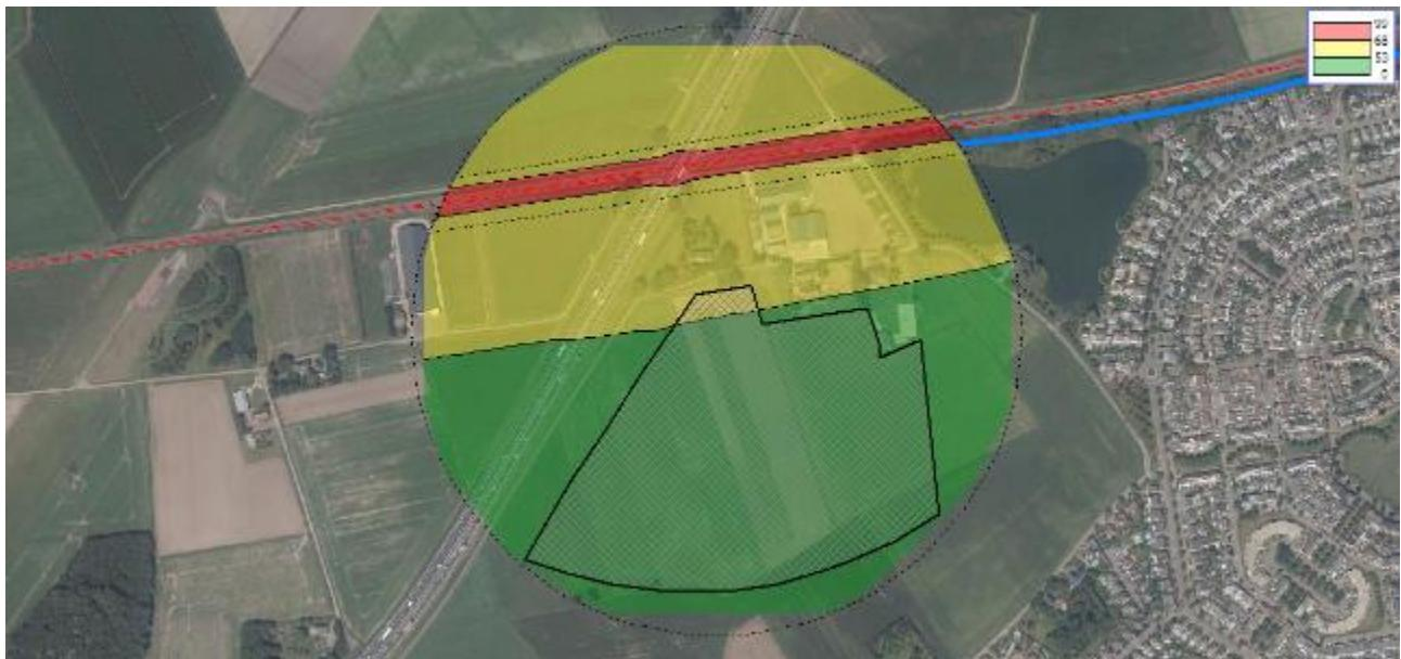
Figuur 41 Geluidcontouren spoorlijn Roosendaal – Bergen op Zoom (contouren op 10 m boven maaiveld)
