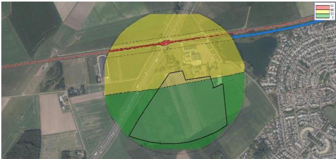
Figuur 43 Geluidcontouren spoorlijn Roosendaal – Bergen op Zoom (contouren op 20 m boven maaiveld)
