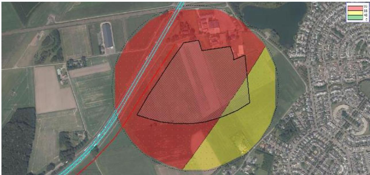
Figuur 30 Geluidcontouren A58 met bronmaatregel tweelaags ZOAB (contouren op 30 m boven maaiveld)
