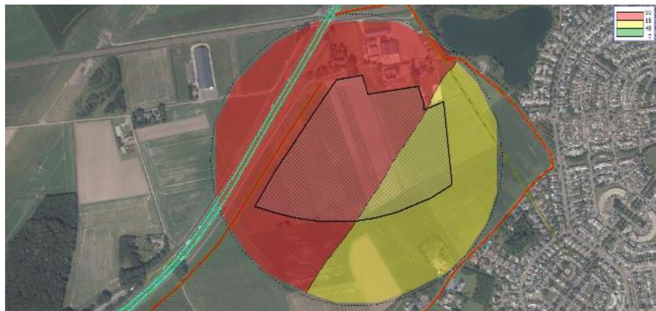
Figuur 17 Geluidcontouren A58 (contouren op 1,5 m boven maaiveld)
