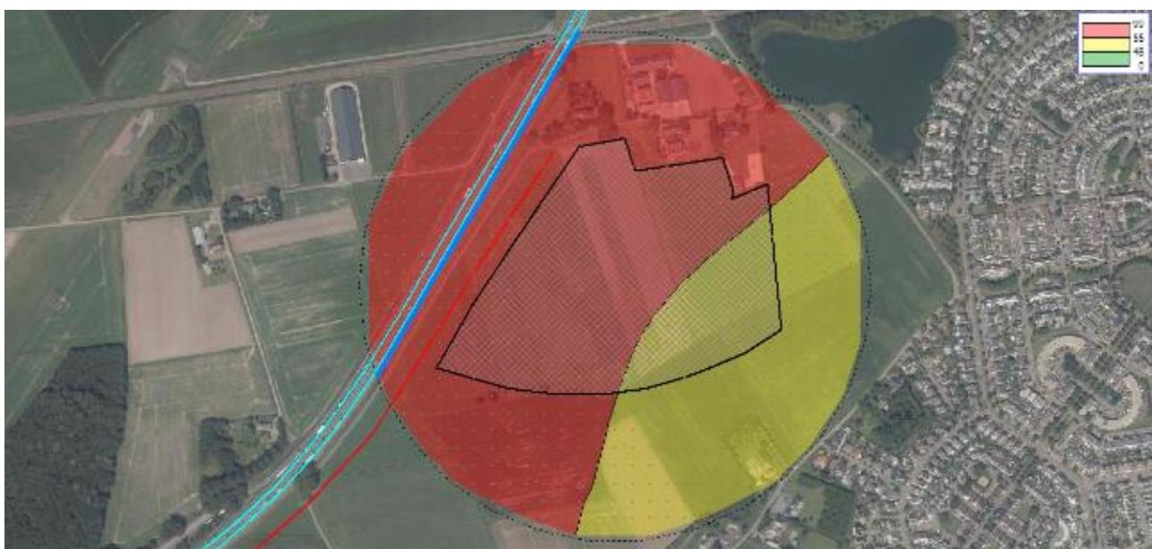
Figuur 37 Geluidcontouren A58 met geluidscherms 3m hoog en 570 m lang (contouren op 30 m boven maaiveld)
