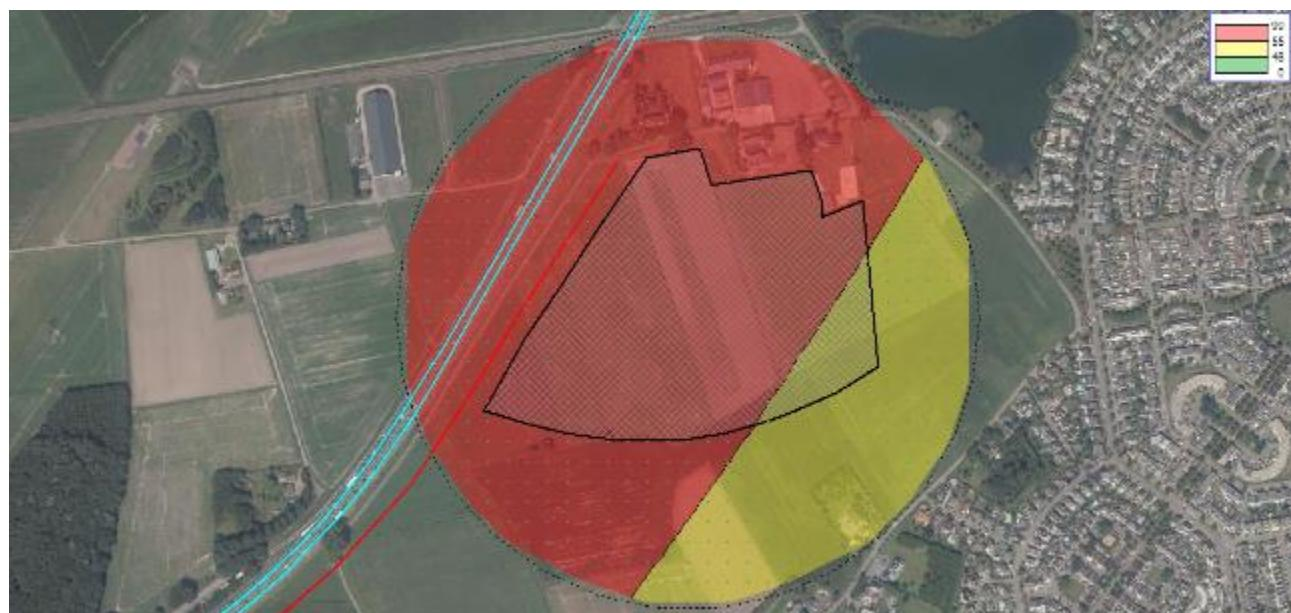
Figuur 29 Geluidcontouren A58 met bronmaatregel tweelaags ZOAB (contouren op 25 m boven maaiveld)
