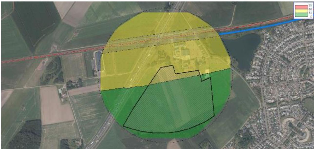
Figuur 45 Geluidcontouren spoorlijn Roosendaal – Bergen op Zoom (contouren op 30 m boven maaiveld)
