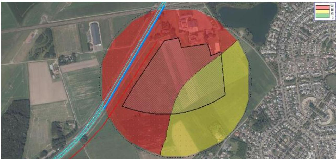
Figuur 36 Geluidcontouren A58 met geluidscherms 3m hoog en 570 m lang (contouren op 25 m boven maaiveld)
