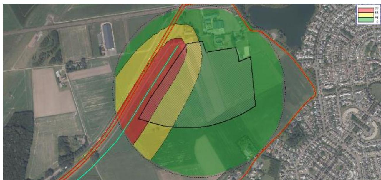
Figuur 5 Geluidcontouren verbindingsweg (contouren op 10 m boven maaiveld)
