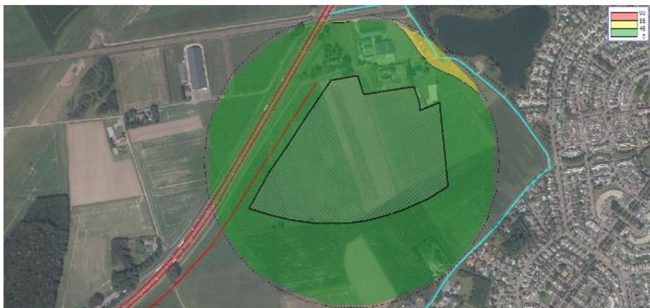
Figuur 15 Geluidcontouren Bulknaarsestraat/Huijbergseweg (contouren op 25 m boven maaiveld)
