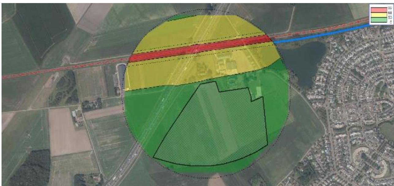
Figuur 39 Geluidcontouren spoorlijn Roosendaal – Bergen op Zoom (contouren op 1,5 m boven maaiveld)
