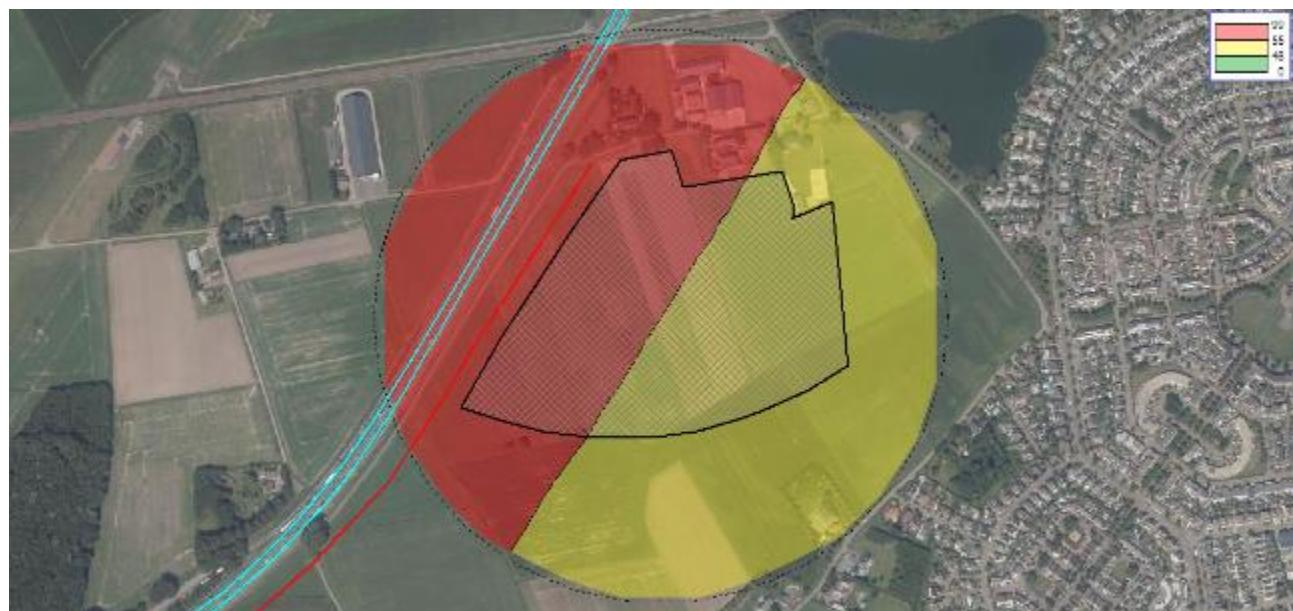
Figuur 24 Geluidcontouren A58 met bronmaatregel tweelaags ZOAB (contouren op 1,5 m boven maaiveld)
