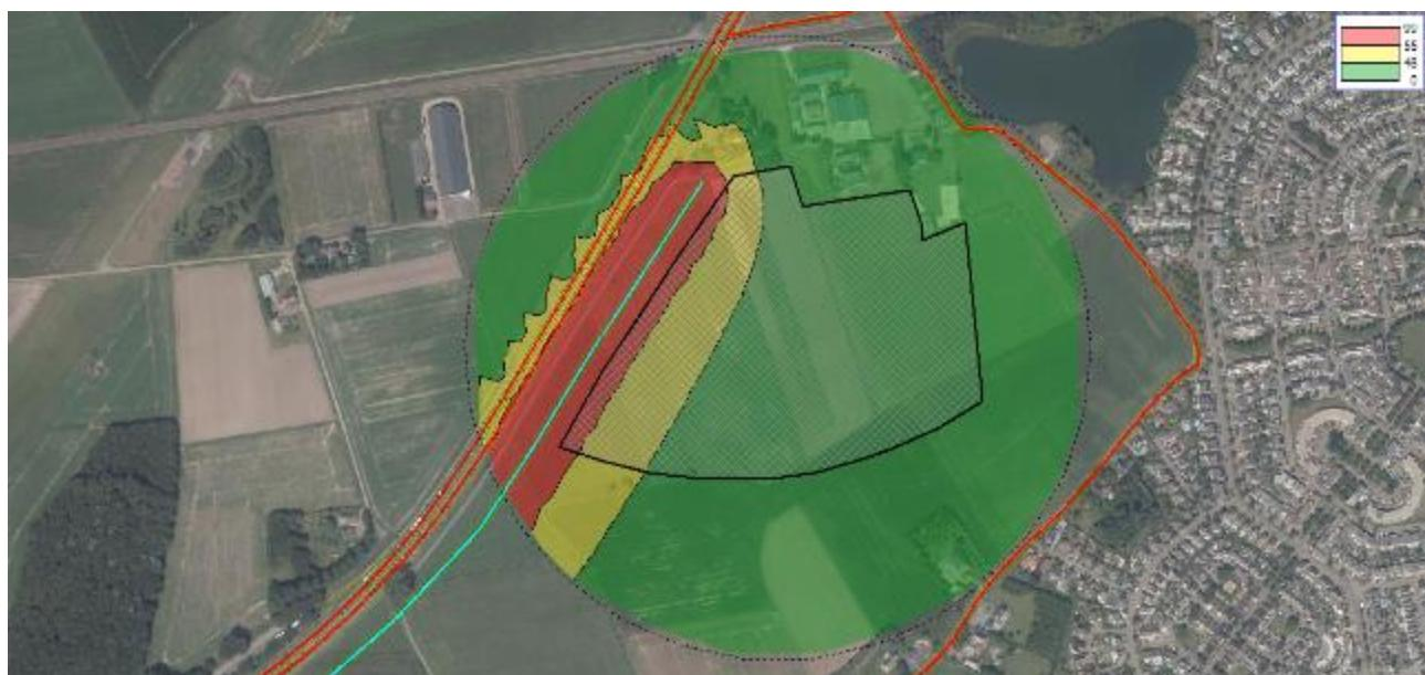
Figuur 3 Geluidcontouren verbindingsweg (contouren op 1,5 m boven maaiveld)
