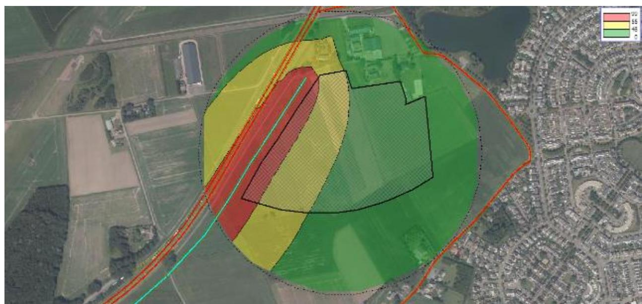
Figuur 7 Geluidcontouren verbindingsweg (contouren op 20 m boven maaiveld)
