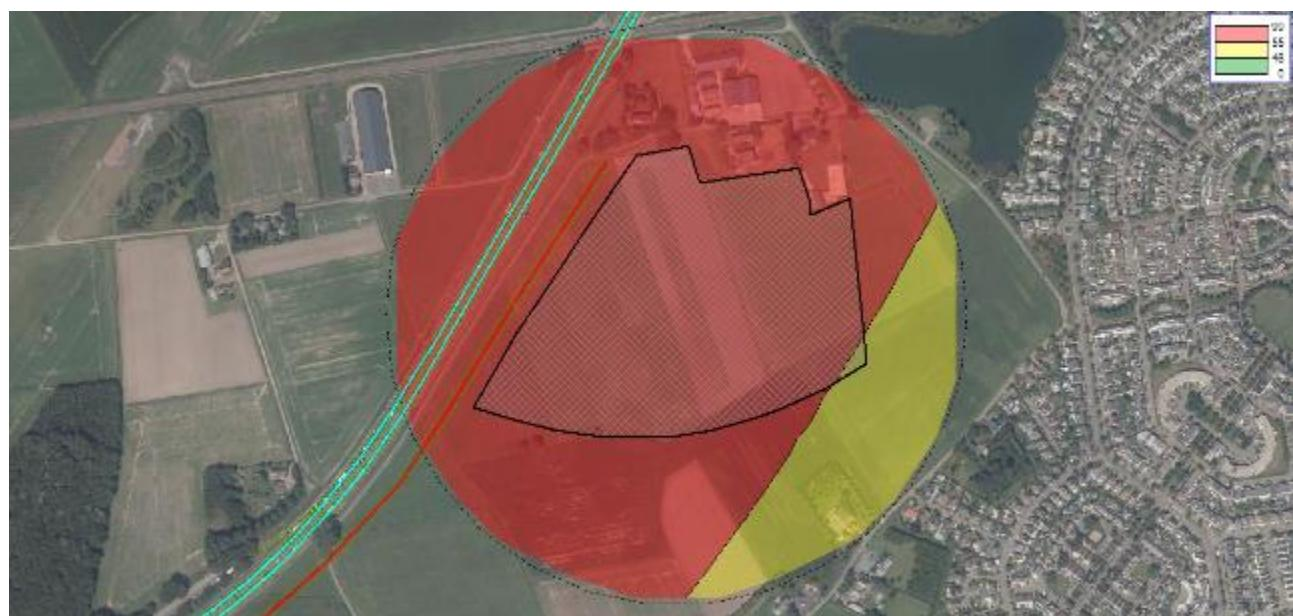
Figuur 20 Geluidcontouren A58 (contouren op 15 m boven maaiveld)
