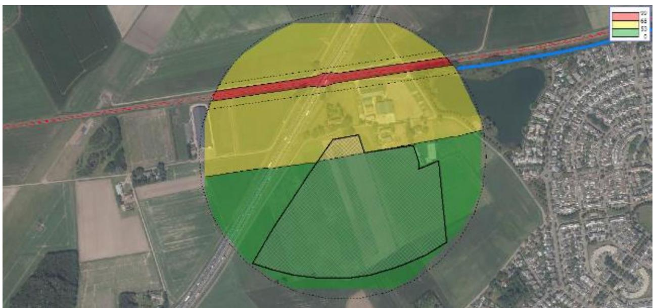
Figuur 42 Geluidcontouren spoorlijn Roosendaal – Bergen op Zoom (contouren op 15 m boven maaiveld)
