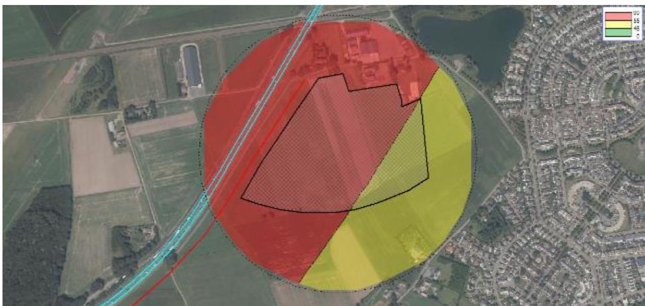
Figuur 27 Geluidcontouren A58 met bronmaatregel tweelaags ZOAB (contouren op 15 m boven maaiveld)
