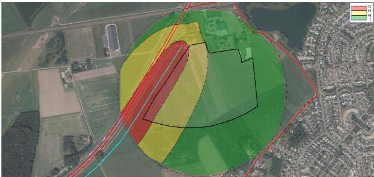
Figuur 8 Geluidcontouren verbindingsweg (contouren op 25 m boven maaiveld)
