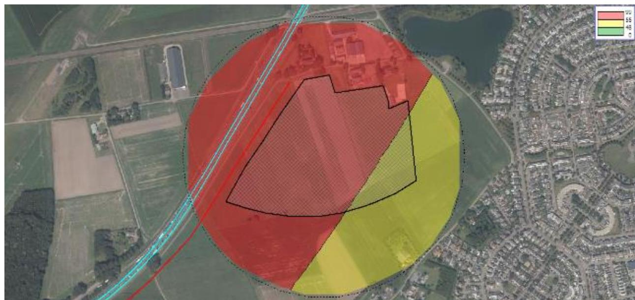
Figuur 28 Geluidcontouren A58 met bronmaatregel tweelaags ZOAB (contouren op 20 m boven maaiveld)
