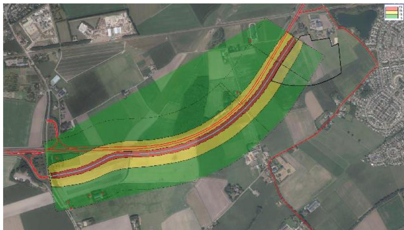
Figuur 49 Geluidcontouren verbindingsweg met verlaging van de rijnsnelheid naar 70 km per uur (contouren op 8 m boven maaiveld)
