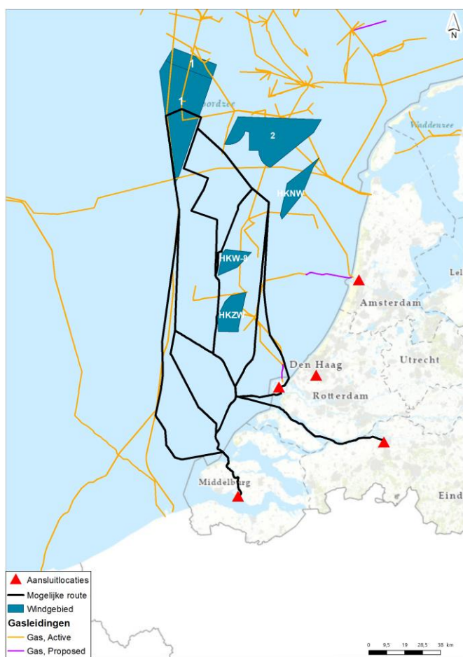
Afbeelding 3.5 Aanwezige gasinfrastructuur Noordzee
