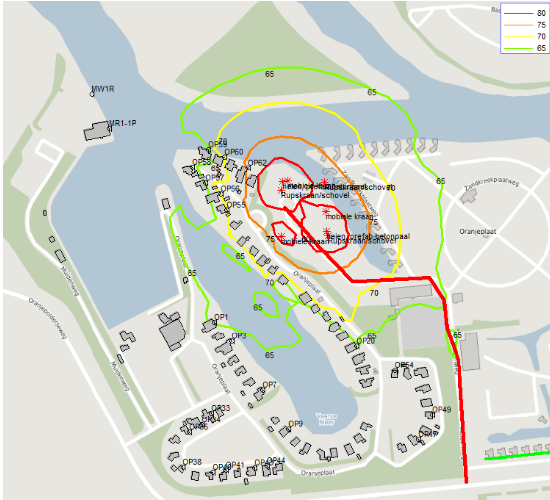
Figuur 6.1 Geluidcontouren bouwlaaai, worstcase tijdens heien met twee stellingen gelijktijdig westzijde plangebied
