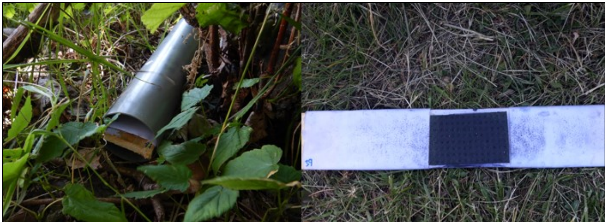
Afb. 3.3.2 Voorbeeld van één van de sporenbuizen gebruikt in het onderzoek.
