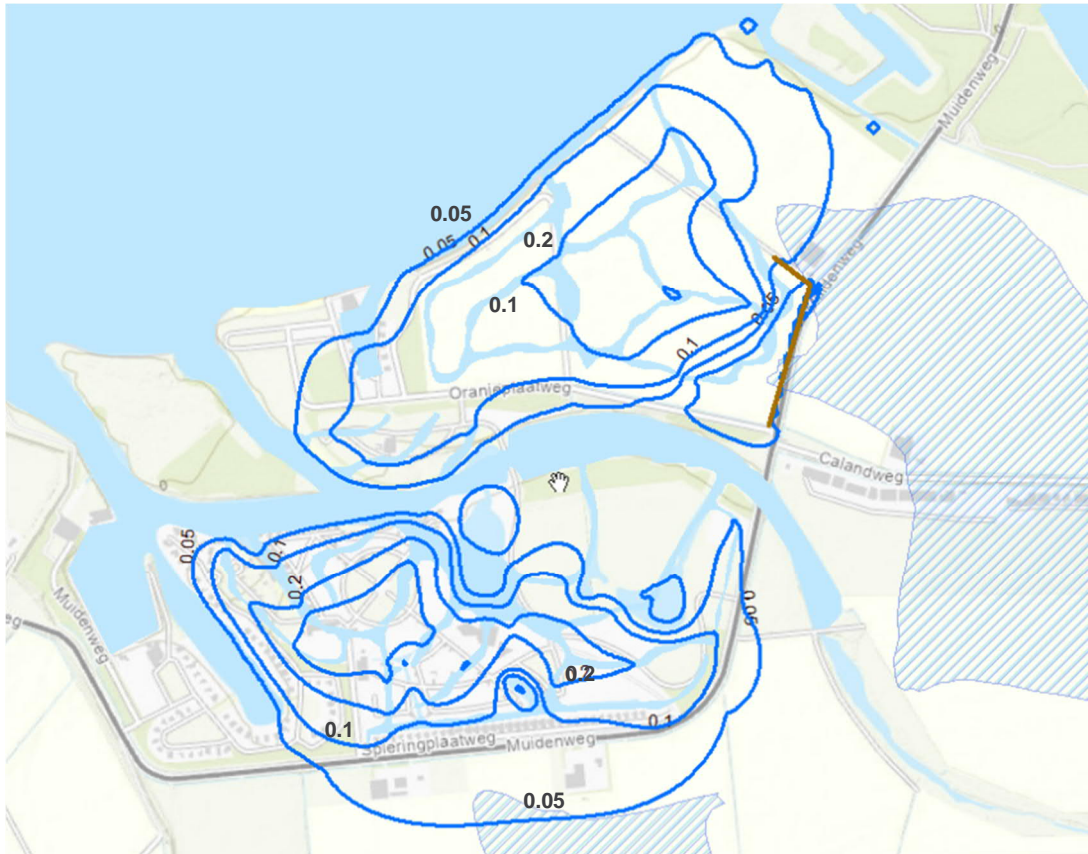
Figuur 4.4 Invloedsgebied met verticaal scherm in noordoostelijke zijde (bruine lijn). zoetwatervoorcomens zijn blauw gearceerd.
