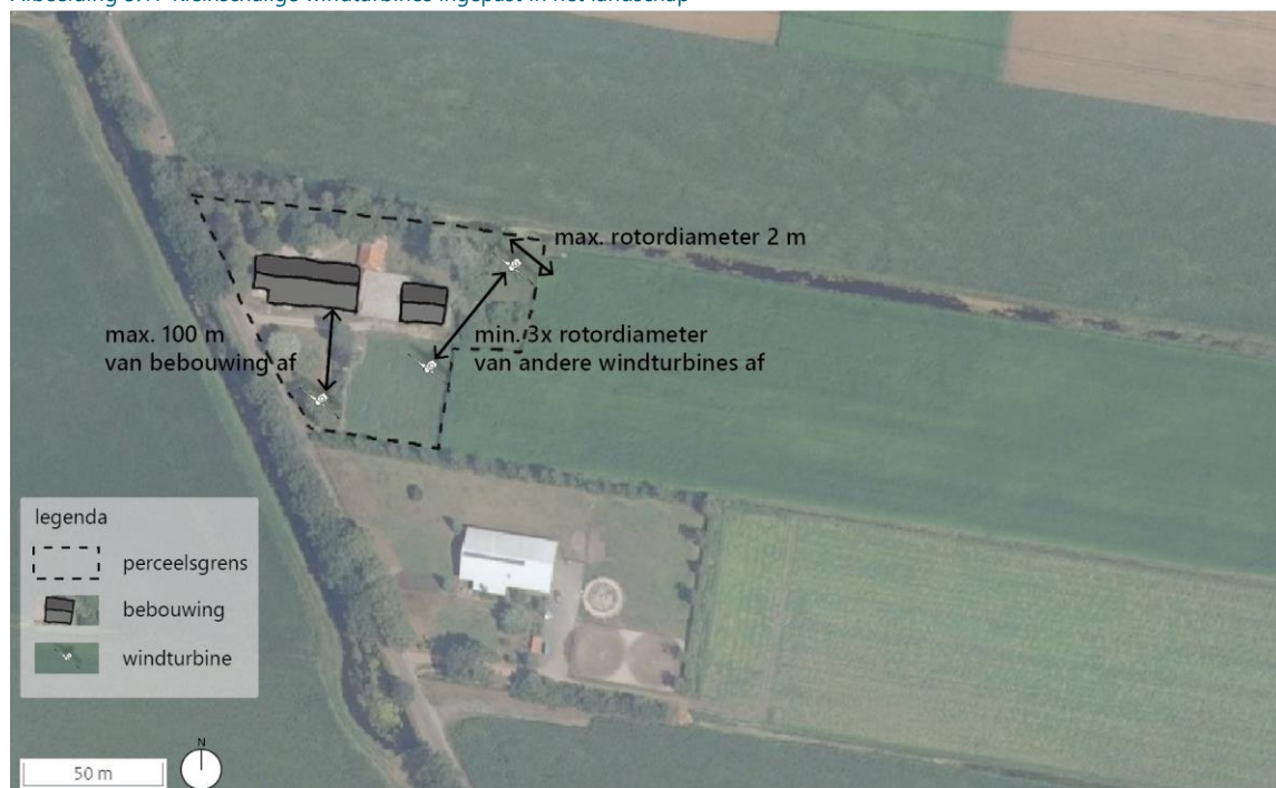
Afbeelding 5.17 Kleinschalige windturbines ingepast in het landschap
