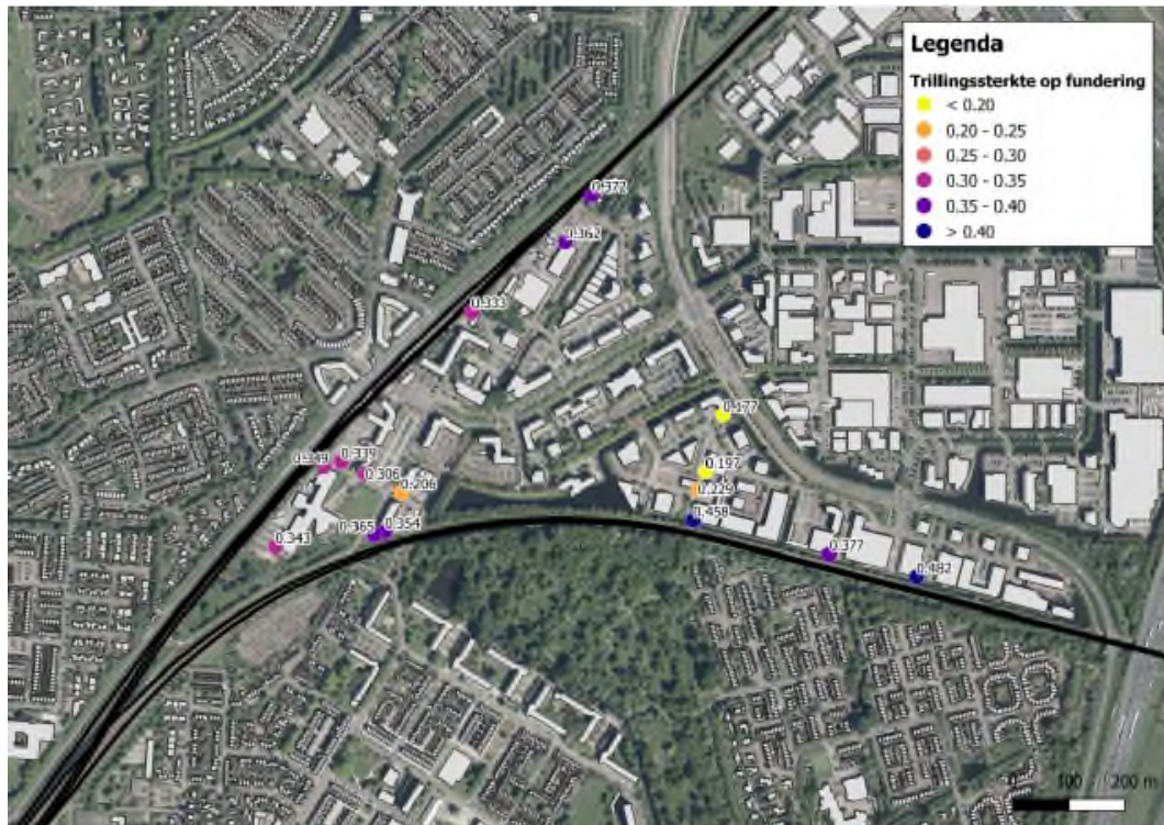
Figuur 5.15: Resultaten trillingenmeting.
