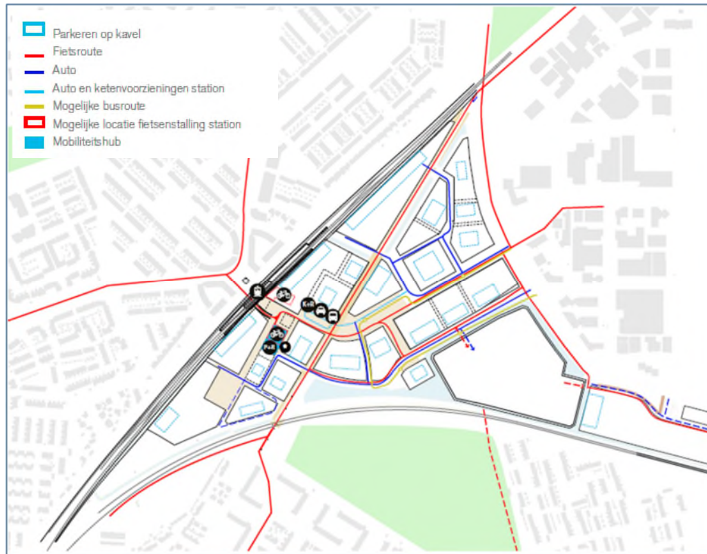
Figuur 4.4: Beoogde verkeersstructuur plansituatie
