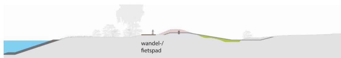
Afbeelding 7.10 Indicatief dwarsprofiel inclusief inlaat (en verlaagde kering)
