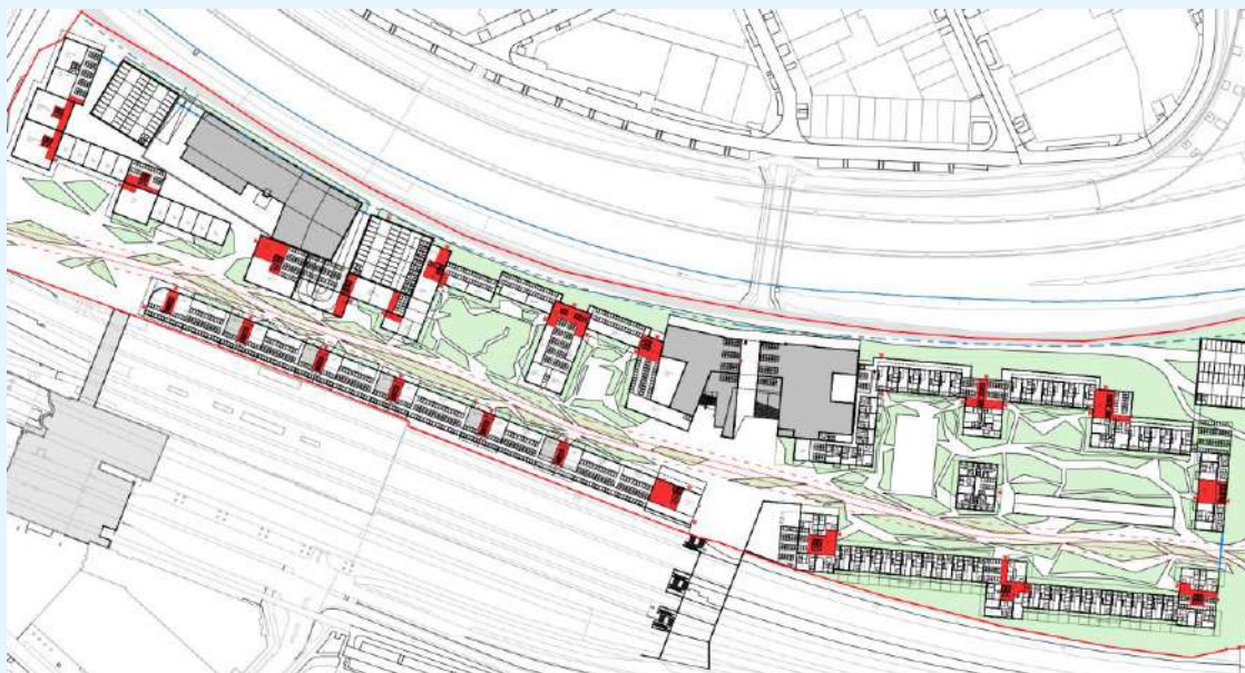
figuur 5: posities voor gebouwtoegangen (activiteit 'slenteren').
