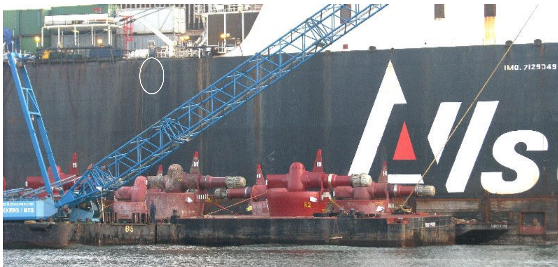
Figuur 3 Enkele thrusters van de pijpenlegger 'Solitaire' (let op de man onder de kraan om een idee te krijgen van de grootte).
