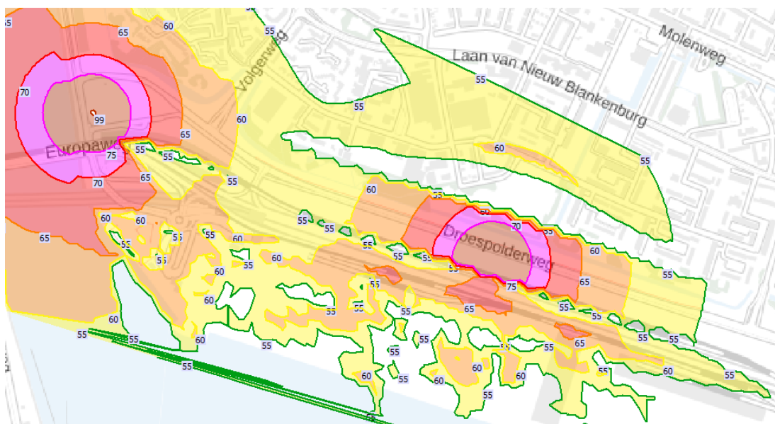
Figuur 8.4 contouren van gelijke geluidbelasting voor twee mogelijk locaties (worst case) voor het intrillen van damwanden
