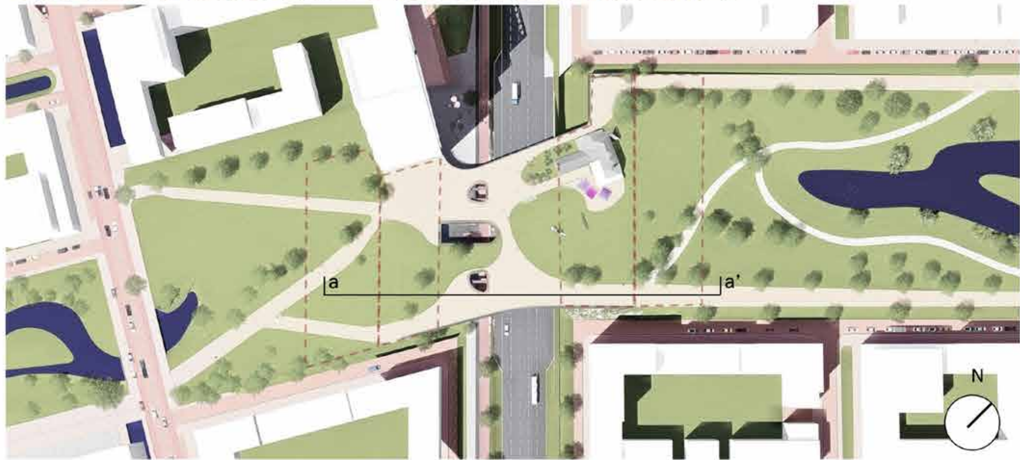
Bovenaanzicht van de verbindende overkluizing en onderliggende parkeergarages met verschillende (daglicht)openingen voor voetgangers en fietsers t.p.v. Het fietspad.
