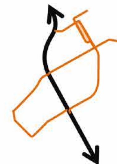
De ringweg ontlast profiel Holterbergweg t.p.v. De Nieuwe Kern: separate busbaan overbodig
