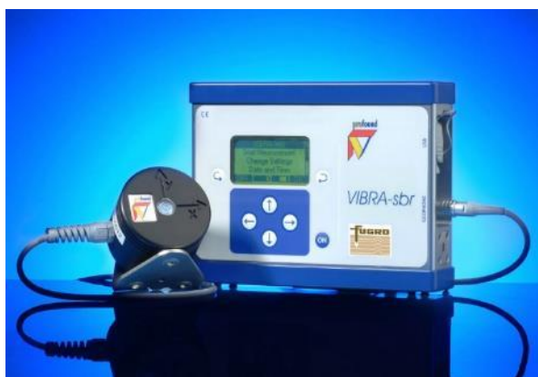
Figuur 2-4: Meetsysteem met opnemer (Vibra+)
