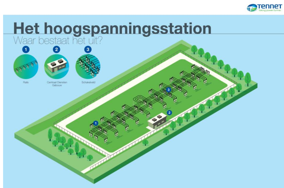
Afbeelding 2.2 Voorbeeldweergave van een hoogspanningsstation TenneT (bron: factsheet TenneT)
