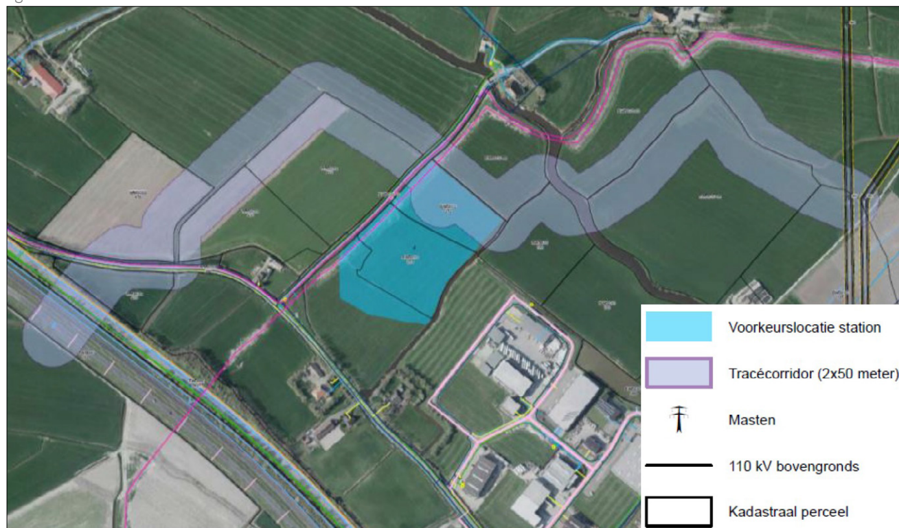
fig. I Locatie station Bolsward met kabeltracés
