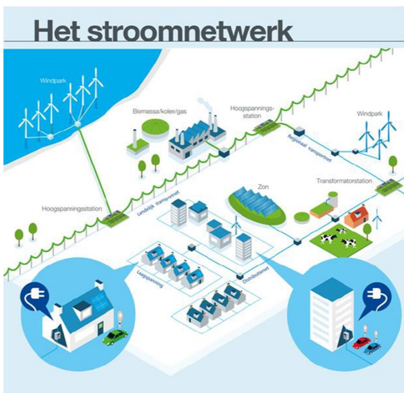
Afbeelding 1.4 Schematische weergave van het stroomnetwerk (bron: TenneT)
