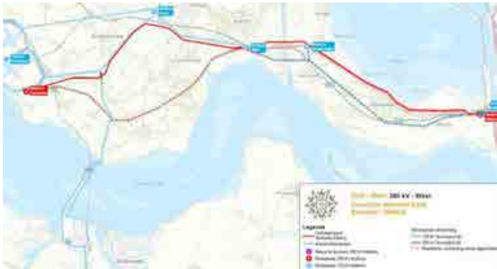
Figuur 10.8 Overzicht definitief tracé Borssele - Rilland 380 kV
