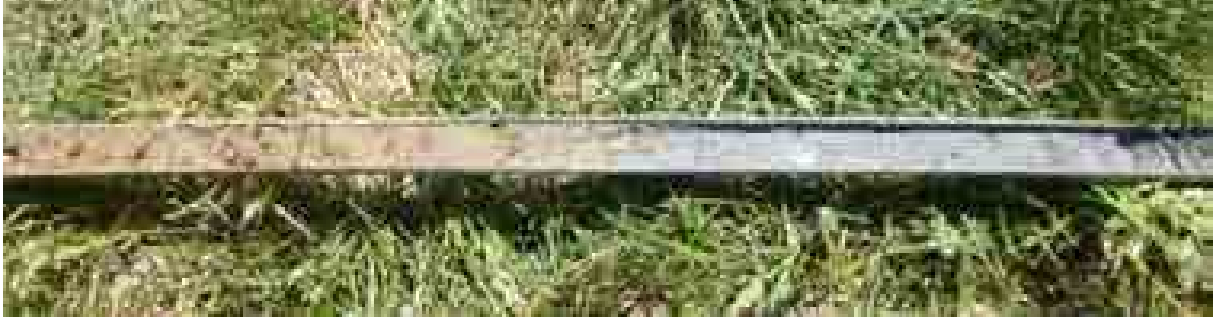
Figuur 27: Foto van het pakket door kleilaagjes onderbroken zand (rechts) zoals dit in de boringen 5 tot en met 8 onder de gerijpte klei (links) is aangetroffen
