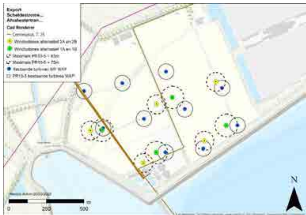
Figuur 5.2 Weergave rioolpersleiding en overdraai cirkels
