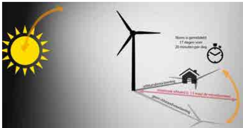
Figuur 8.1 Schematische weergave slagschaduw en werking norm
