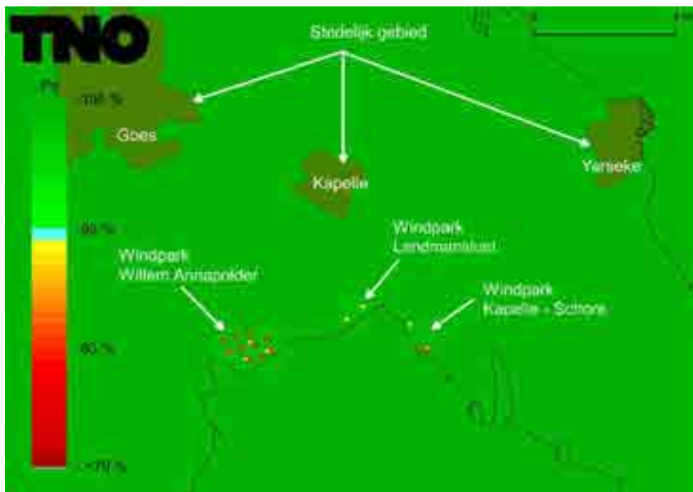
Figuur 8 Detectiekans van het primaire verkeersleidingsradarnetwerk op 1000 voet boven het bouwplan nadat deze is gerealiseerd. De rode kruizen geven de locaties aan van de te verwijderen windturbine en de gele stippen geven de locaties aan van de nieuwe windturbines.
