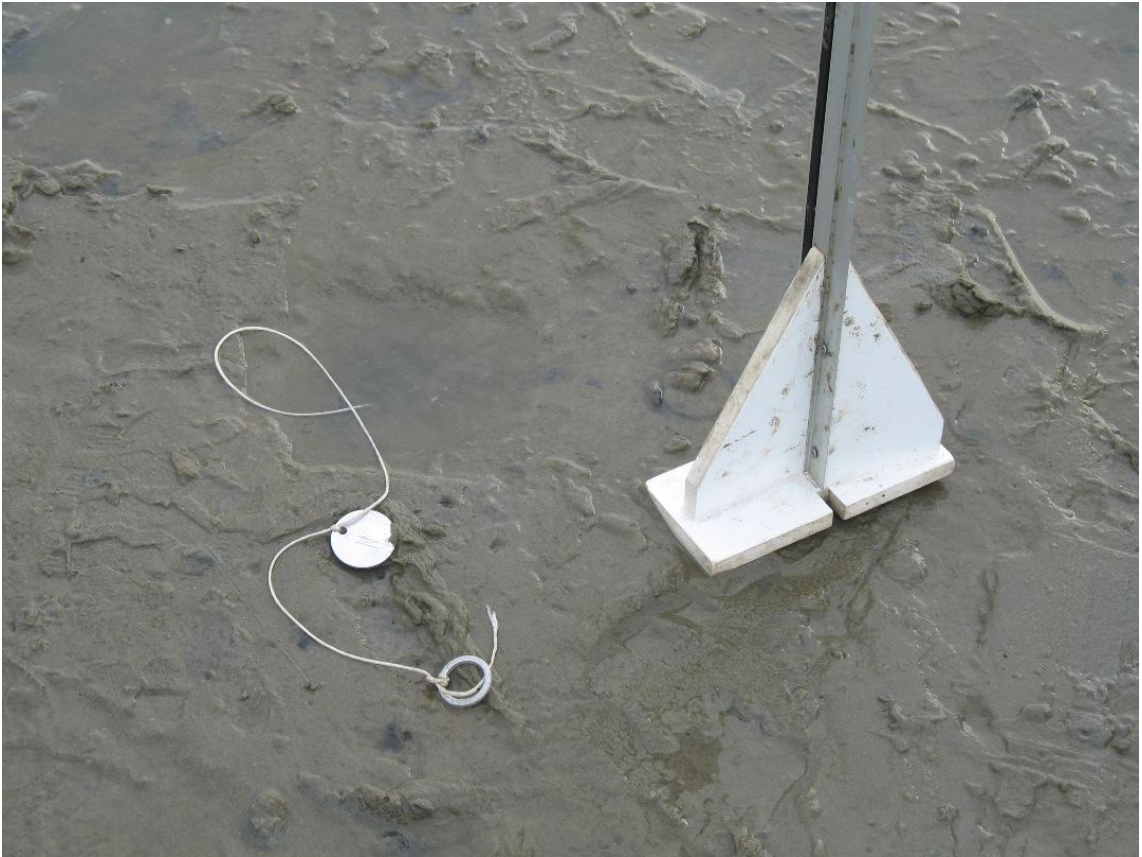
Figuur 2.3 Meetlijn met meetvoet. Deze wordt steeds op dezelfde wijze op de bodem gezet waarna de lengte van het meettouw langs de schaal wordt afgelezen.
