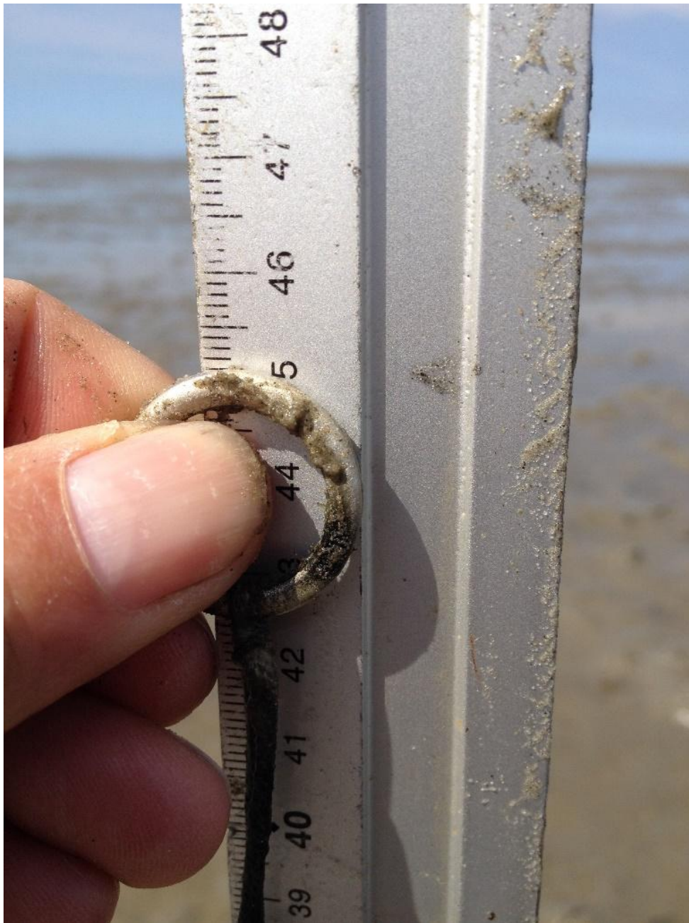
Figuur 2.4 Aflezing van een meting tussen de bodem en de bovenkant van een ring. In dit geval 45,1 cm.
