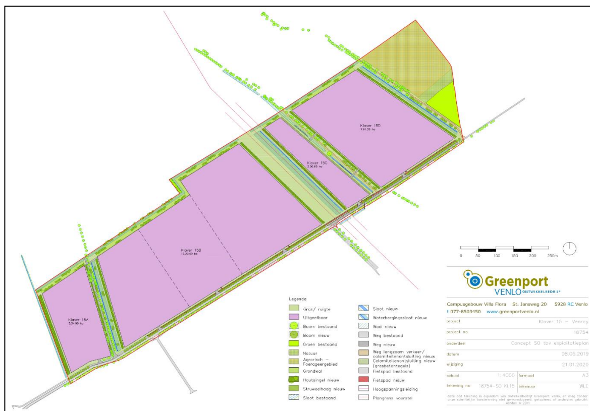
Figuur 3. Een voorlopig schetsontwerp van de voorgenomen plannen (Greenport Venlo, d.d. 21-01-2020) waarbij paars uitgeefbaar gebied vormt, groen geeft beplanting of groene elementen weer, de rode lijn geeft de ligging van een hoogspanningskabel weer en aan de oostzijde wordt (in het groen) een compensatiegebied ingericht voor diverse (beschermde) soorten.
