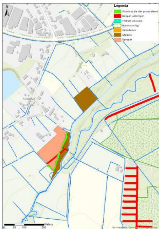
Figuur 8-7 Demping van oude watergang bij Zeelberg, locatie waar nieuwe waterloop als vlak is gemodelleerd en aanpassing aan maaiveld
