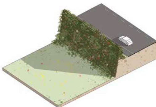
Figuur 7.2: VIP-principe combinatie grondkering met geluidscherm afgewerkt met begroeide schanskorf (deelgebied Haaglanden)
