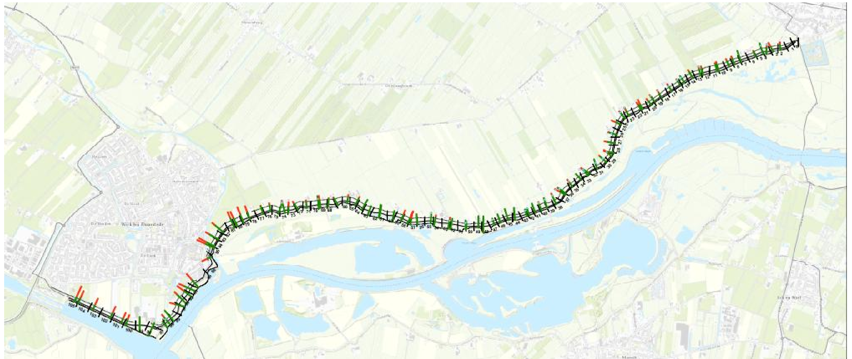
Figuur 3-4 Overzicht kwelweglengtetekort per dijkvak
