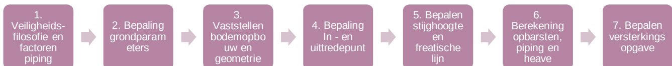
Figuur 3-1 Stappen voor beoordeling piping en heave
