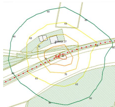
Figuur 2: Geluidscontouren zuilenbekleding verwijderen
