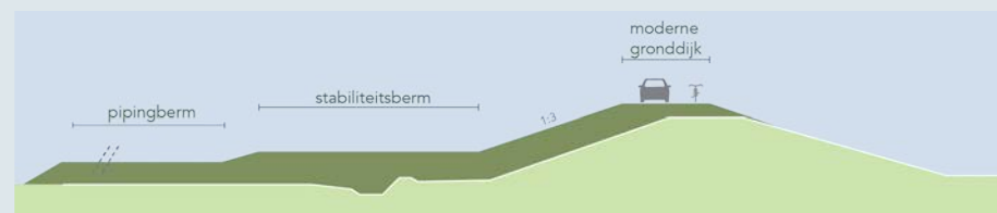
Afbeelding 3.1 Ruimte aan de binnenzijde voor stabiliteit binnenzijde en pipingberm
