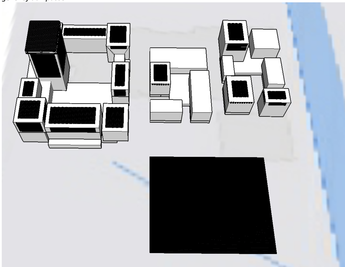
Figuur 4.7 – Referentiebeeld PV-panelen bij NOM. Het naastliggende vlak zijn de PV-panelen die niet op gevel of dak passen.
