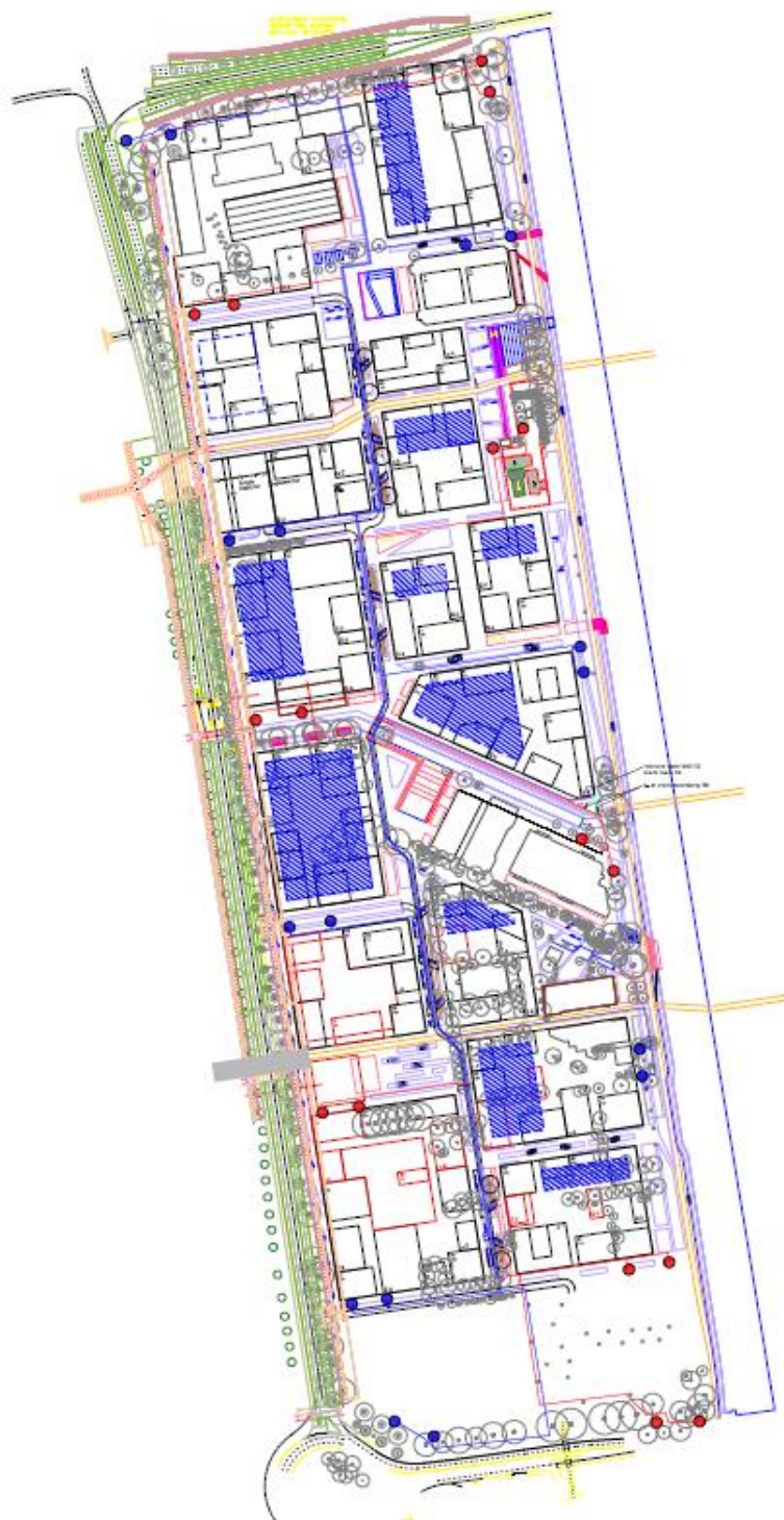
Figuur 6.2 – Open bronnen met 16 doubletten in Merwede
