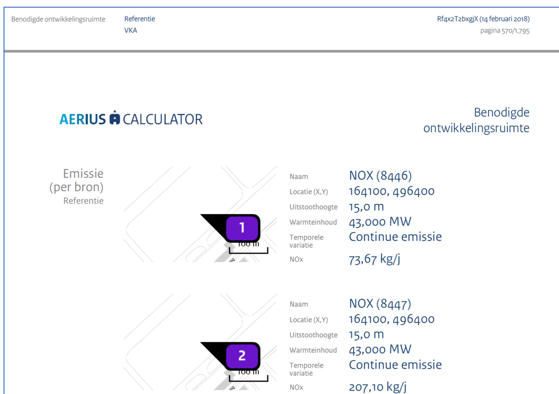
Figuur 7: Bron 1 en 2 van de referentiesituatie volgens de AERIUS-herberekening uit 2018 t.b.v. hernieuwde PAS-melding als gevolg van de MER-actualisatie. Warmte-inhoud is nu 43 MegaWatt.
