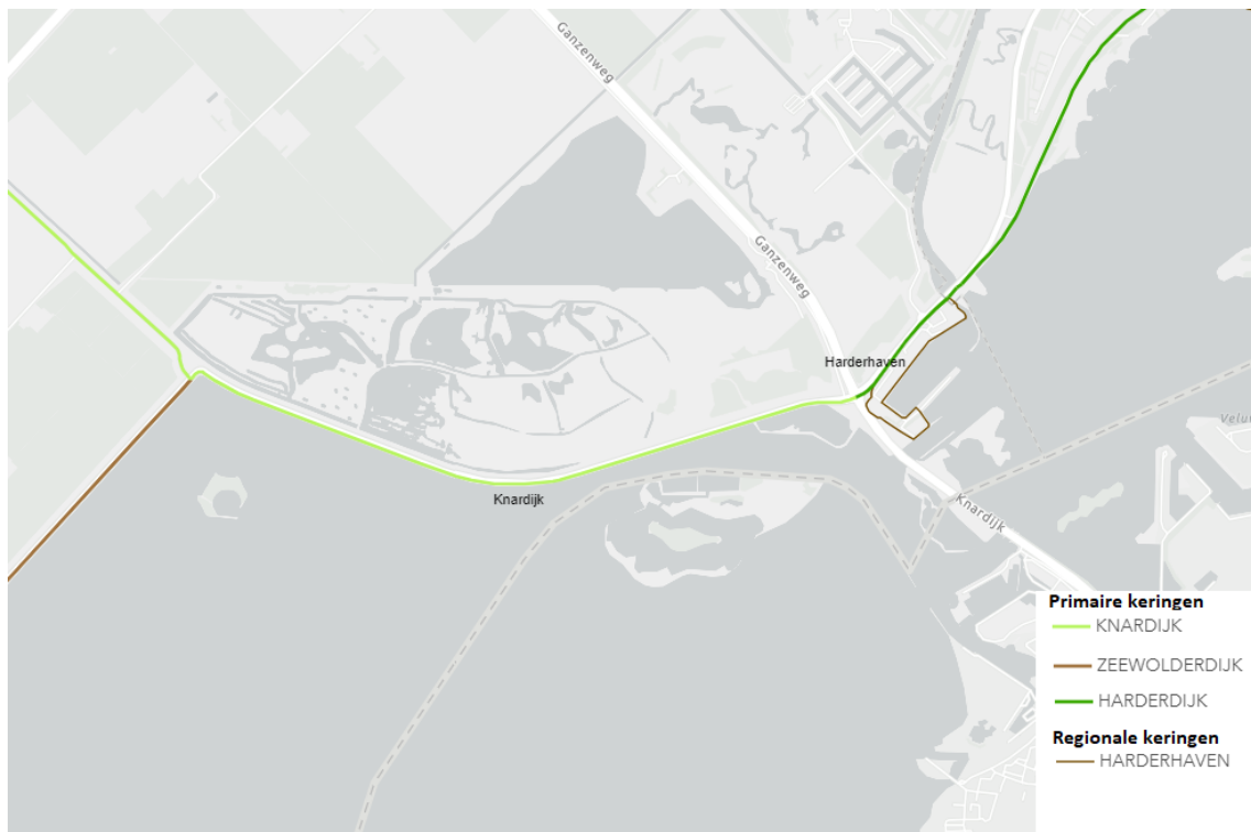
Figuur 2.3 Waterkeringen in omgeving (Legger Waterschap Zuiderzeeland, 2019)
