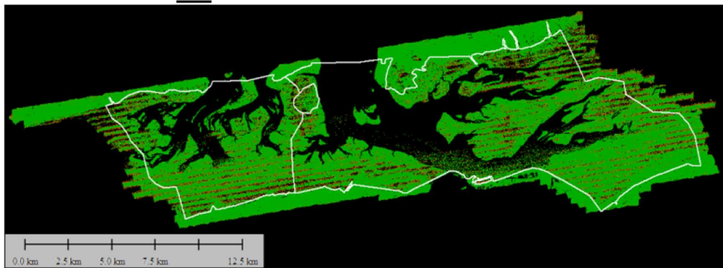
Figuur 17: Puntendichtheid van de LiDAR opnames van het najaar van 2014. Groen: \geq 4 punten per m^2 , rood: < 4 punten per m^2 , zwart: geen data of data beneden -0,7m NAP. Dit is een uitsnede van figuur 3.1 uit Vroom en Beekhuizen (2015).
