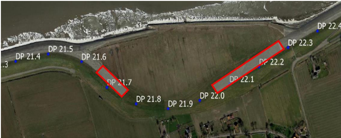
Figuur 13: Ligging van de dijkpalen in buitendijks gebied bij Stroe, hier voldoet de grasbekleding niet op het aspect Golfklap
