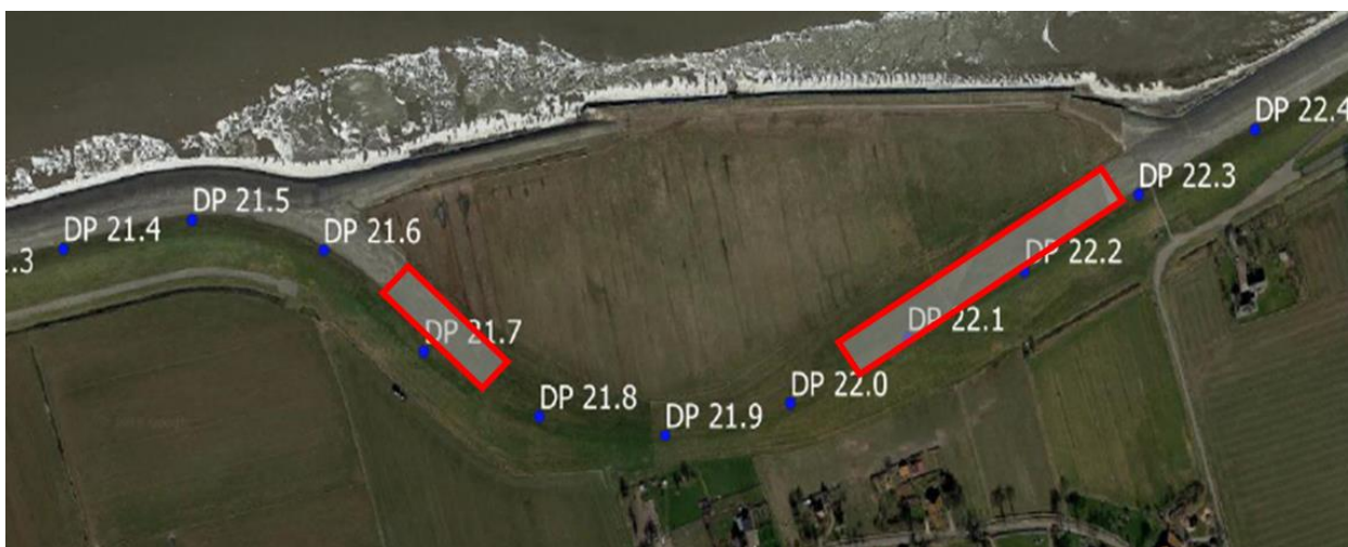
Figuur 3-7: Ligging van de stukken dijk waarvan de grasbekleding niet voldoet op het aspect golfklap bij Stroe
