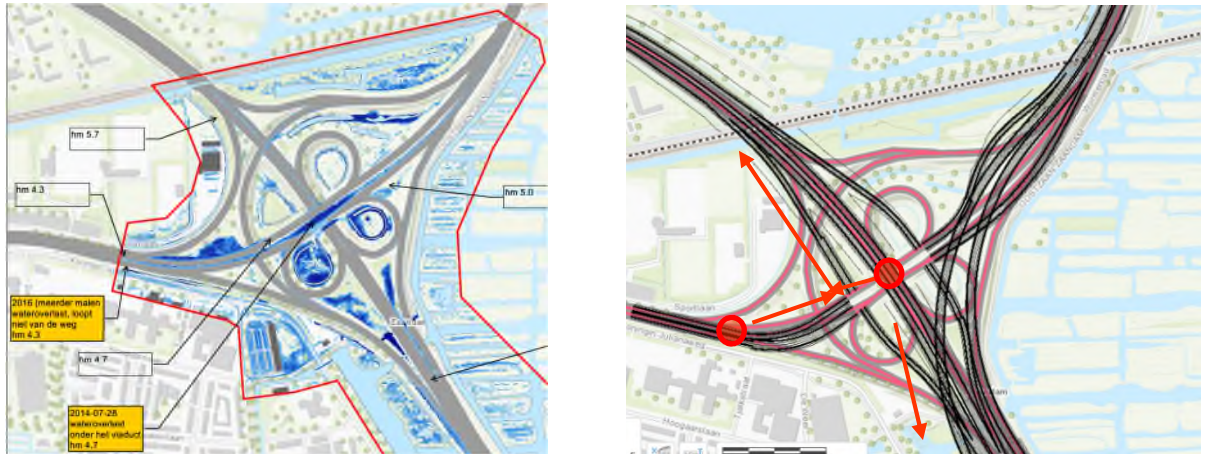
Figuur 3.24: aandachtspunten afvoer regenwater heftige buien knooppunt Zaanstad
