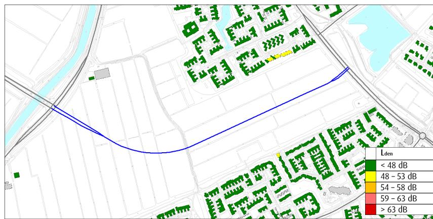
*Figuur 4.1: Overzicht van de woningen waar sprake is van een overschrijding van de voorkeursgrenswaarde van 48 dB in de situatie zonde maatregelen*
