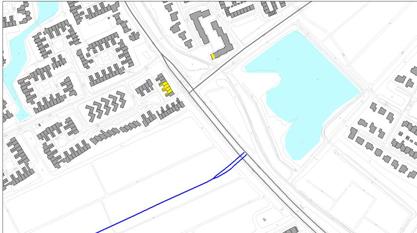
*Figuur 4.3: Woningen (geel) waarvoor ten gevolge van de Zuidpolderlaan een reconstructiesituatie in de zin van de Wet geluidhinder berekend is*
