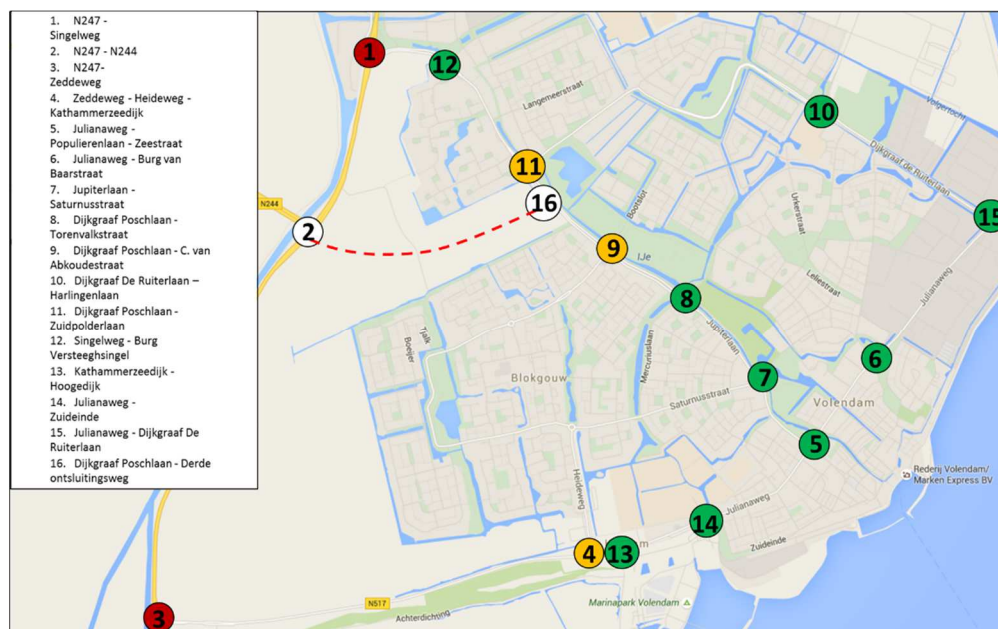
Figuur 6.1: Overzicht van de verkeersafwikkeling van de kruispunten in de autonome situatie 2030 zonder de woonwijk Lange Weeren (rood is slecht, geel is matig, groen is goed, wit: kruispuntvorm nog te bepalen)
