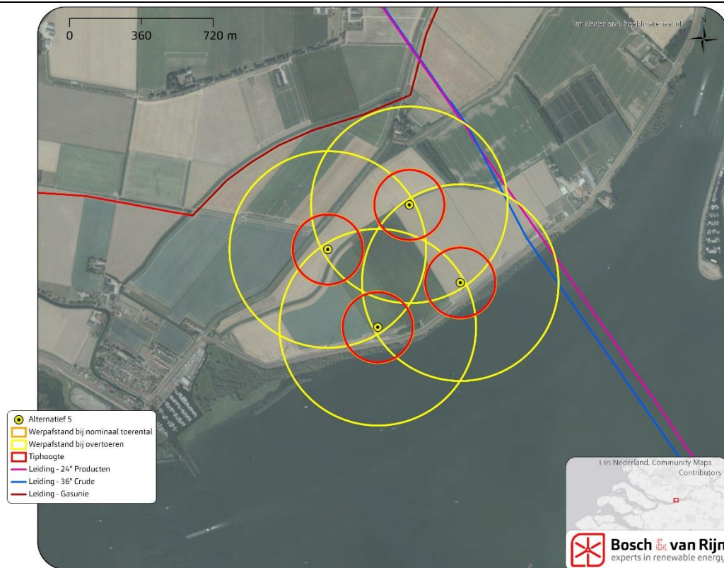
Figuur 21 De verschillende faalscenario's en buisleidingen
