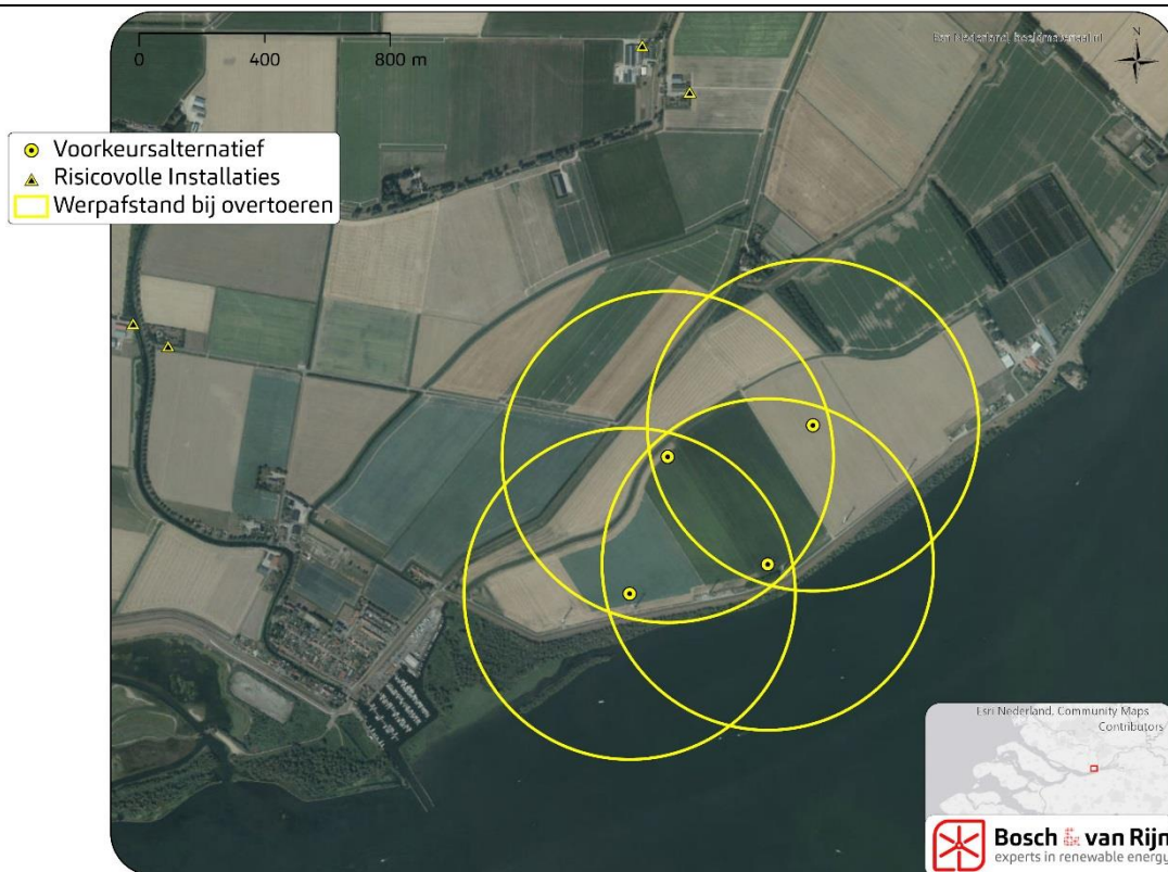
Figuur 36 Maximale werpafstand bij overtoeren van de windturbines en risicovolle installaties
