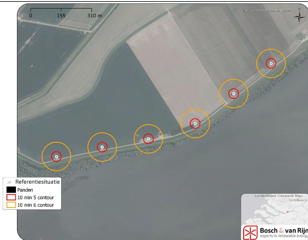
Figuur 4 Risicocontouren rond de windturbines ( Referentiesituatie)
