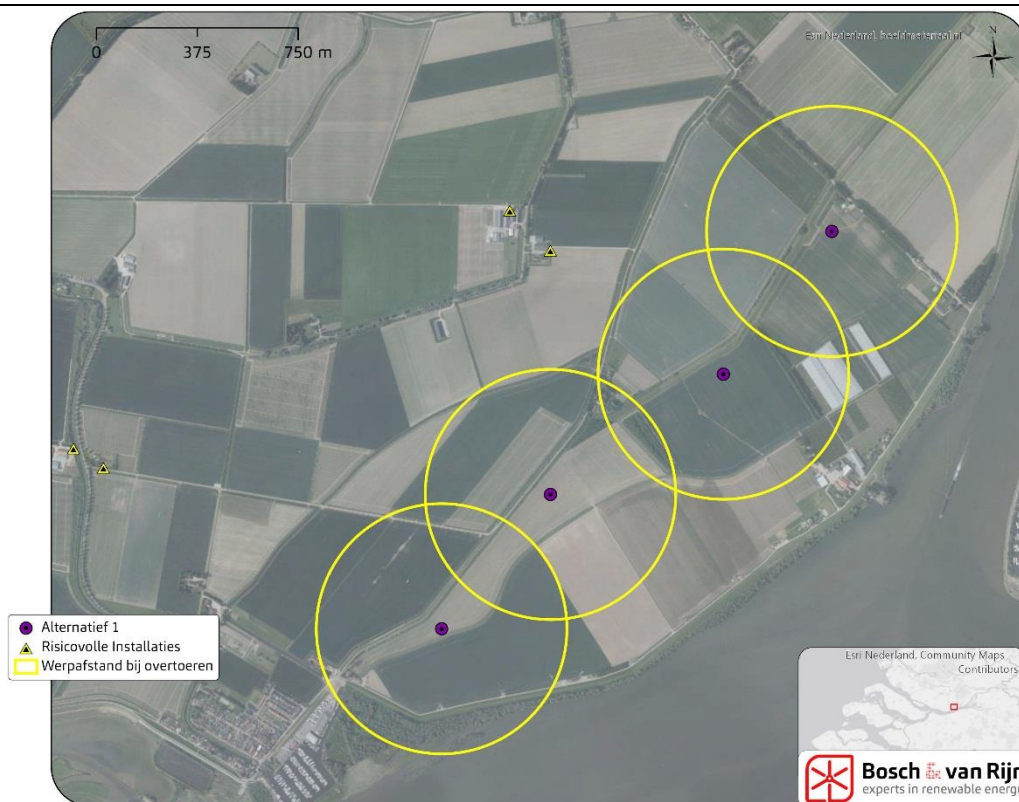
Figuur 11 Maximale werpafstand bij overtoeren van de windturbines en risicovolle installaties
