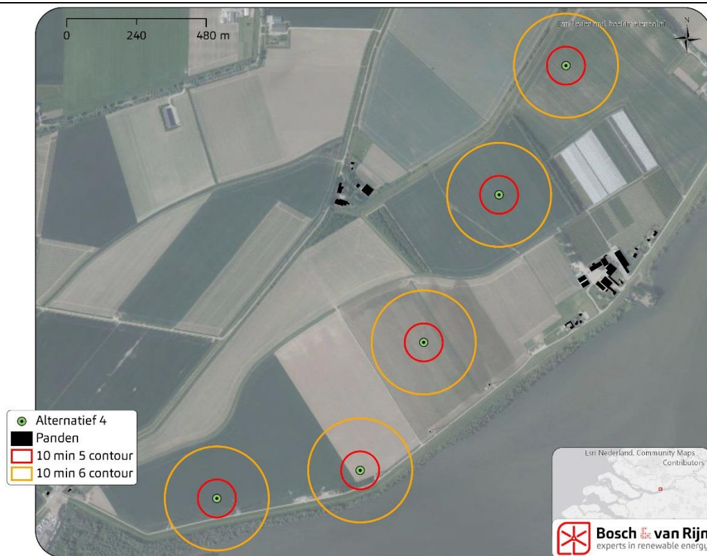
Figuur 8 Risicocontouren rond de windturbines (Alternatief 4)
