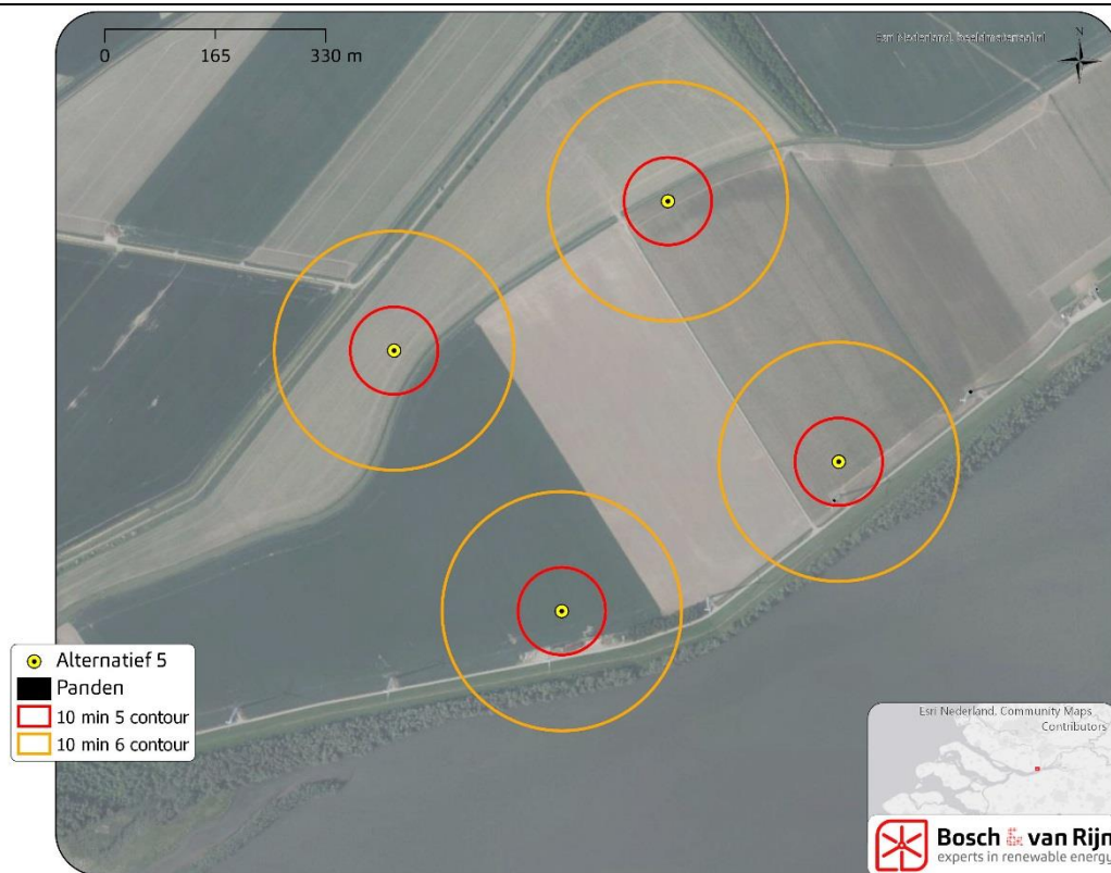
Figuur 9 Risicocontouren rond de windturbines (Alternatief 5)
