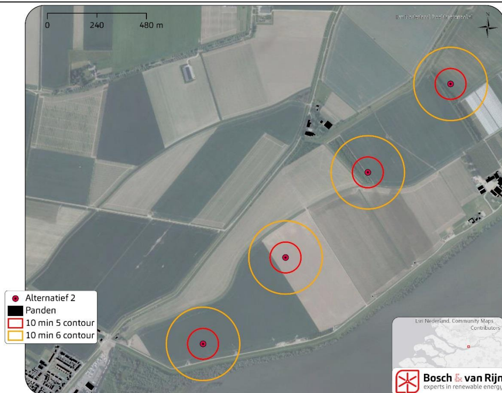
Figuur 6 Risicocontouren rond de windturbines (Alternatief 2)
