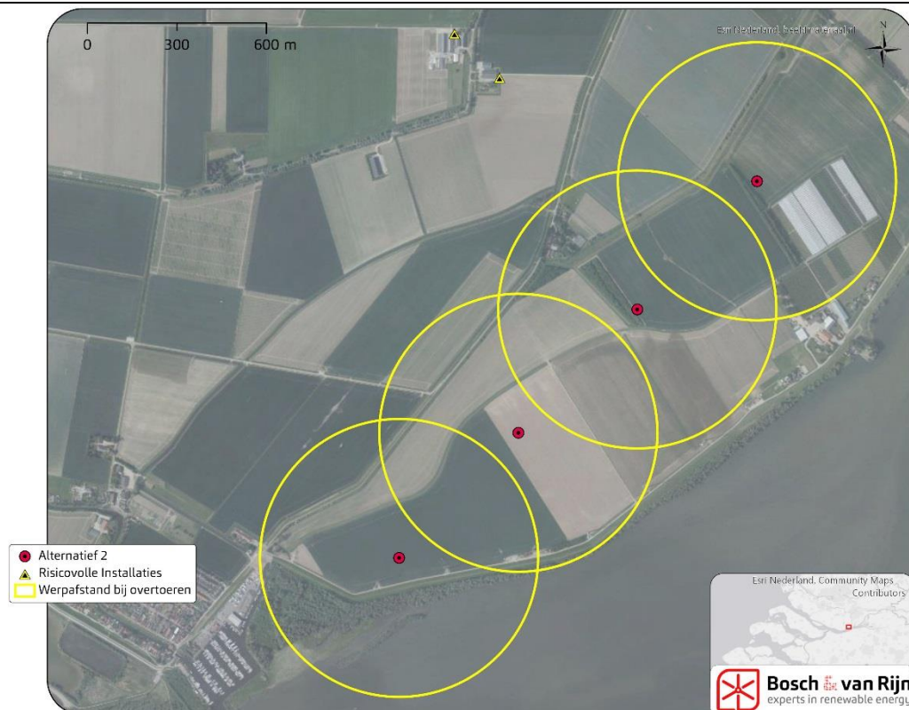
Figuur 12 Maximale werpafstand bij overtoeren van de windturbines en risicovolle installaties
