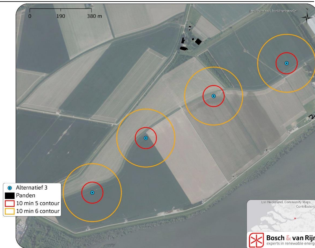
Figuur 7 Risicocontouren rond de windturbines (Alternatief 3)
