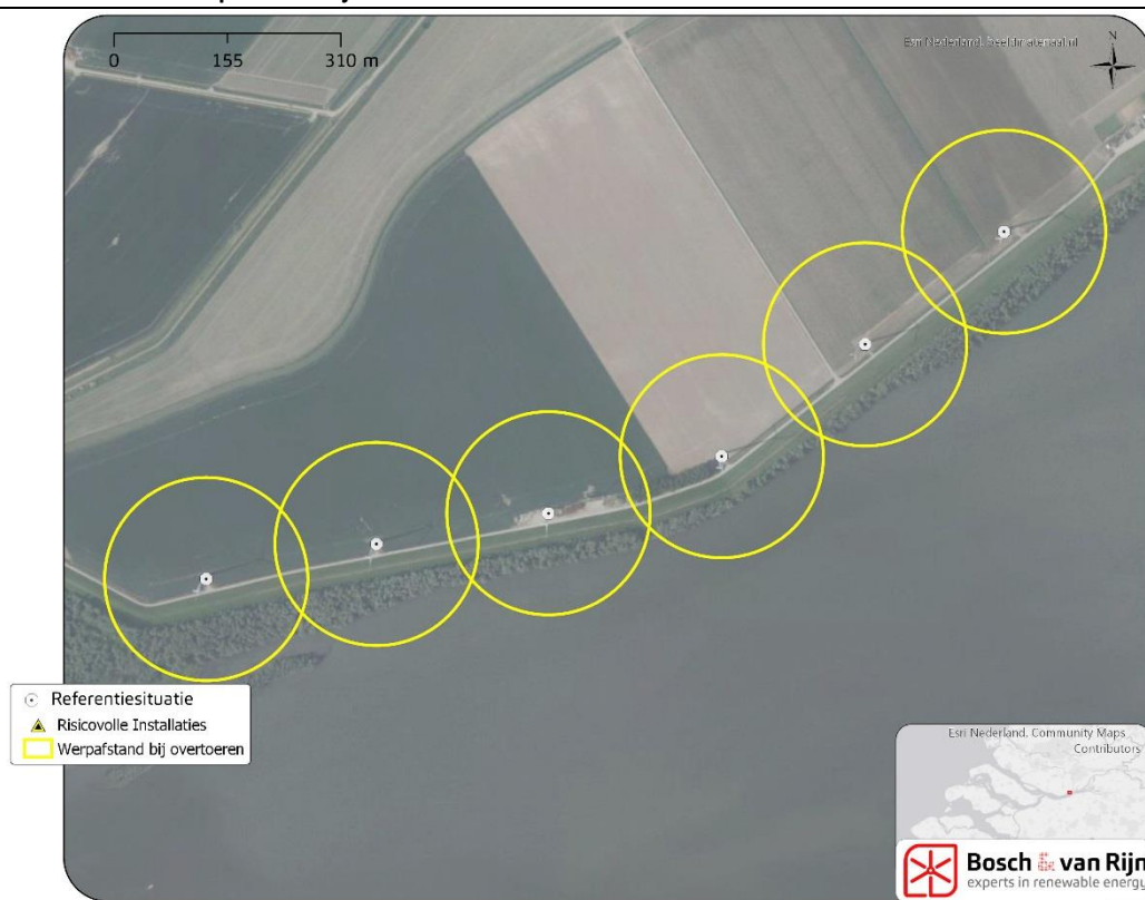
Figuur 10 Maximale werpafstand bij overtoeren van de windturbines en risicovolle installaties.
