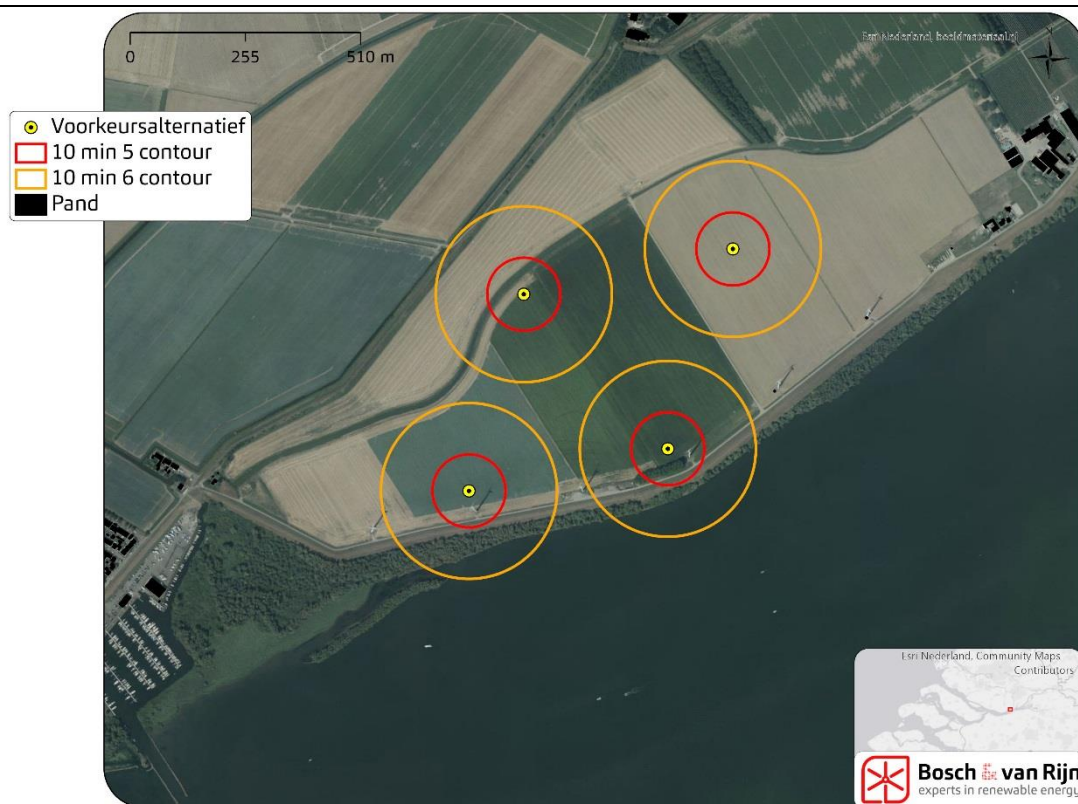
Figuur 35 Risicocontouren rond de windturbines
