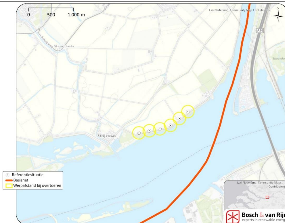
Figuur 23 Werpafstand bij overtoeren en basisnet
