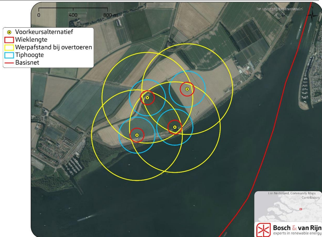
Figuur 42 Werpafstand bij overtoeren en basisnet
