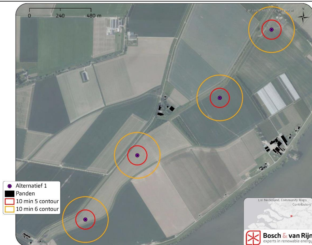
Figuur 5 Risicocontouren rond de windturbines (Alternatief 1)
