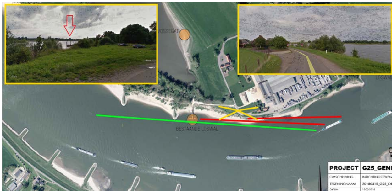
Figuur 3.5: zichtlijnen afvarend schip met laad- en losfaciliteit huidige locatie. De rode lijnen tonen de zichtlijnen waarin het zicht belemmerd wordt, de groene lijnen tonen de onbelemmerde zichtlijnen. De gele lijnen tonen het perspectief van de foto's in de gele kaders.
