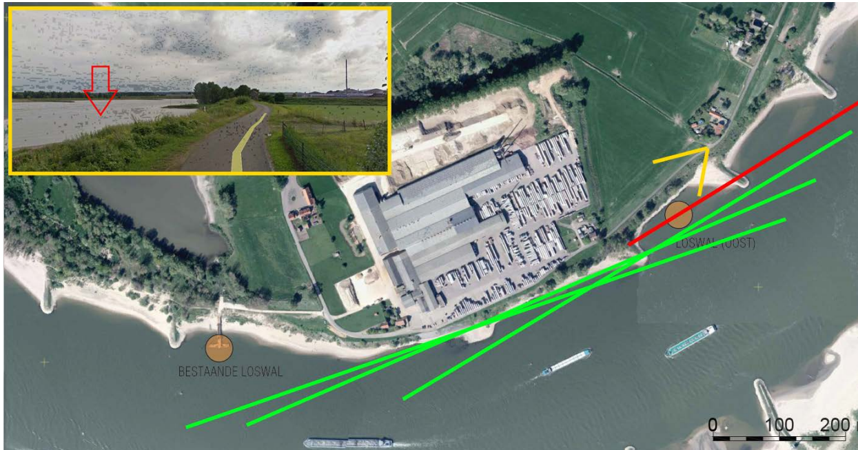
Figuur 3.6: zichtlijnen afvarend ship met laad- en losfaciliteit oost. De rode lijnen tonen de zichtlijnen waarin het zicht belemmerd wordt, de groene lijnen tonen de onbelemmerde zichtlijnen. De gele lijnen tonen het perspectief van de foto in het gele kaders.
