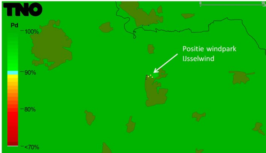
Figuur 6 Detectiekans van het primaire verkeersleidingsradarnetwerk op 1000 voet boven het bouwplan nadat deze is gerealiseerd. De locatie van de nieuwe windturbines is aangegeven met blauwe stippen.
