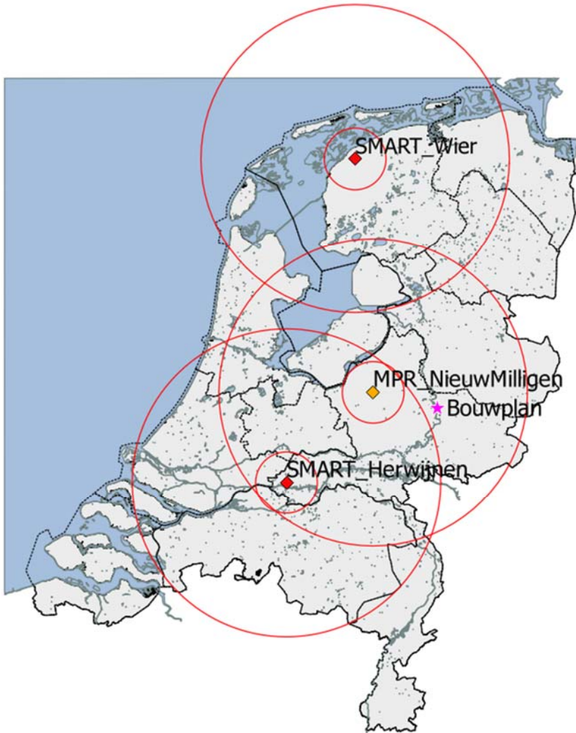
Figuur 3. Locaties van de nieuwe SMART-L EWC GB gevechtsleidingsradars (rode ruit) en de bestaande MPR (oranje ruit) met daaromheen de 15 en 75 km cirkels. De donkergrijze vlakken zijn de in de AHN-1 gedefinieerde stedelijke gebieden. De ligging van het te toetsen bouwplan is aangegeven met een roze ster.
