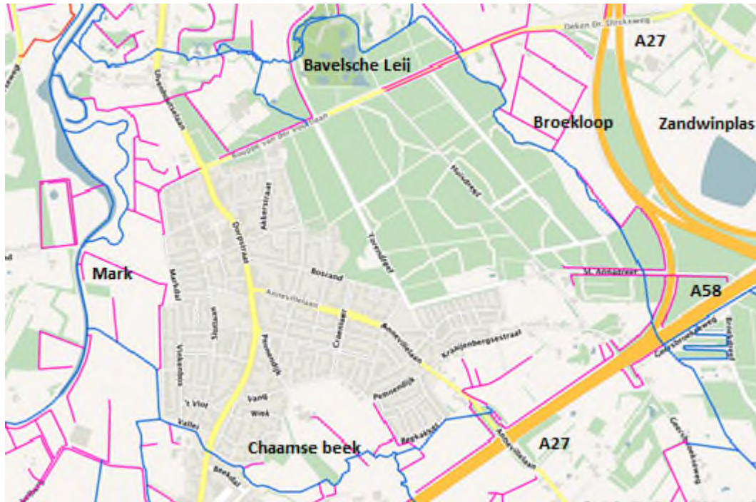
Figuur 3.5. De Mark, de A watergangen (blauw) en B watergangen (rood) in het gebied rond het Ulvenhoutse bos (bron: legger van het waterschap Brabantse Delta) alsmede de locatie van een zandwinplas oostelijk van de A27.
