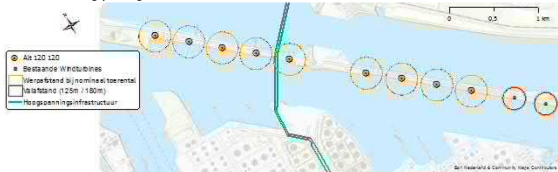
Figuur 19 Werpafstand bij nominaal toerental en valafstand van de windturbines en hoogspanningsinfrastructuur
