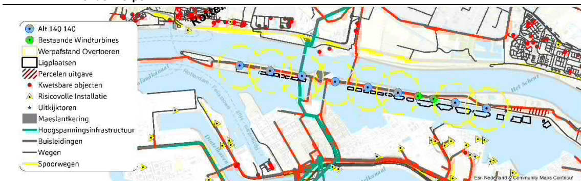
Figuur 3 Werpafstand bij overtoeren van Alternatief 140/140 met voor Externe Veiligheid relevante onderwerpen
