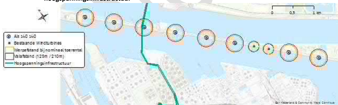
Figuur 20 Werpafstand bij nominaal toerental en valafstand van de windturbines en hoogspanningsinfrastructuur
