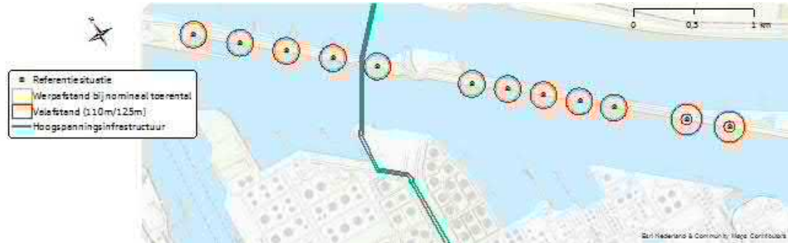
Figuur 17 Werpafstand bij nominaal toerental en valafstand van de windturbines en hoogspanningsinfrastructuur
