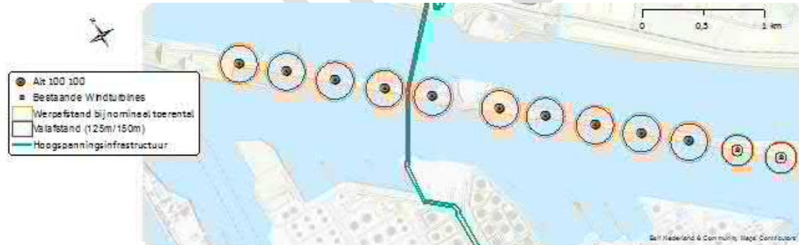
Figuur 18 Werpafstand bij nominaal toerental en valafstand van de windturbines en hoogspanningsinfrastructuur
