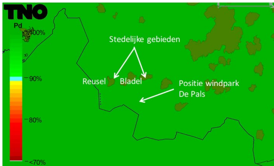
Figuur 5 Detectiekans van het primaire verkeersleidingsradarnetwerk op 1000 voet boven het bouwplan voordat dit is gerealiseerd (baseline).
