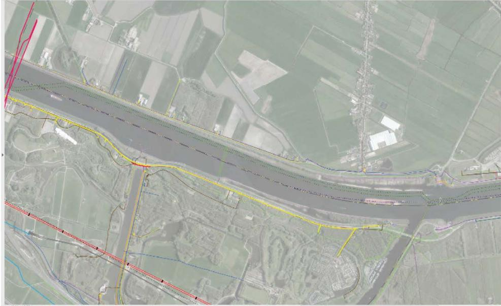
**Figuur 5-3** Overzicht kabel tracé door het Noordzeekanaal (dd 19 juni 2017), groene lijn is de kabel; locatie 3 (pont Spaandam-Assendelft)
