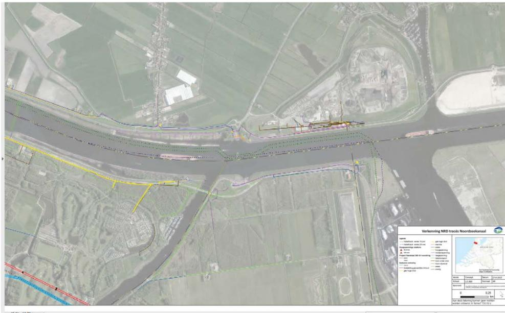
**Figuur 5-4** Overzicht kabel tracé door het Noordzeekanaal (dd 19 juni 2017), groene lijn is de kabel; locatie 4 (aanlanding voor Afrikahaven)
