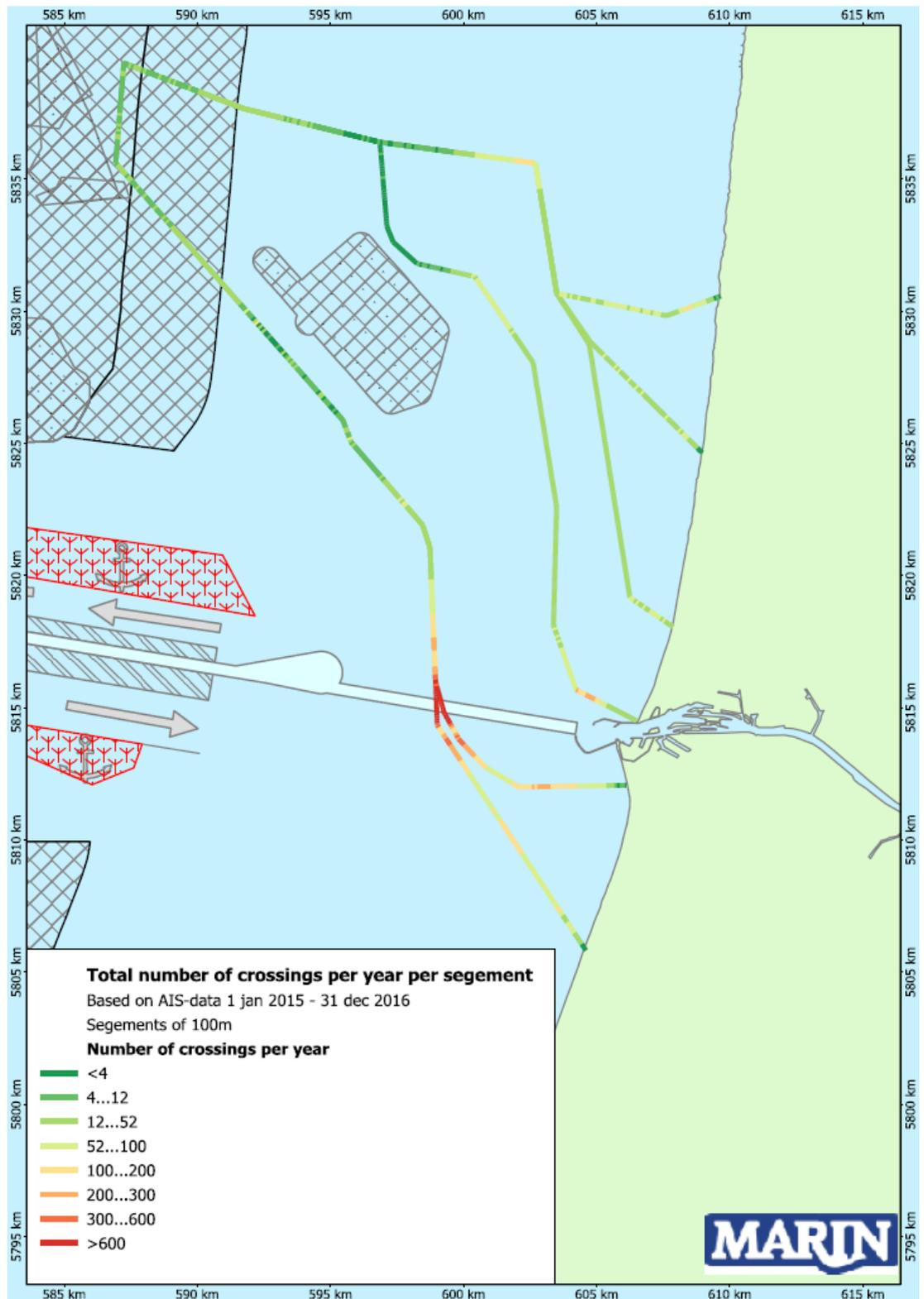
Figuur 4-3 Totaal aantal scheepspassages per jaar (gebaseerd op AIS-data 2015-2016) per tracésegment.
