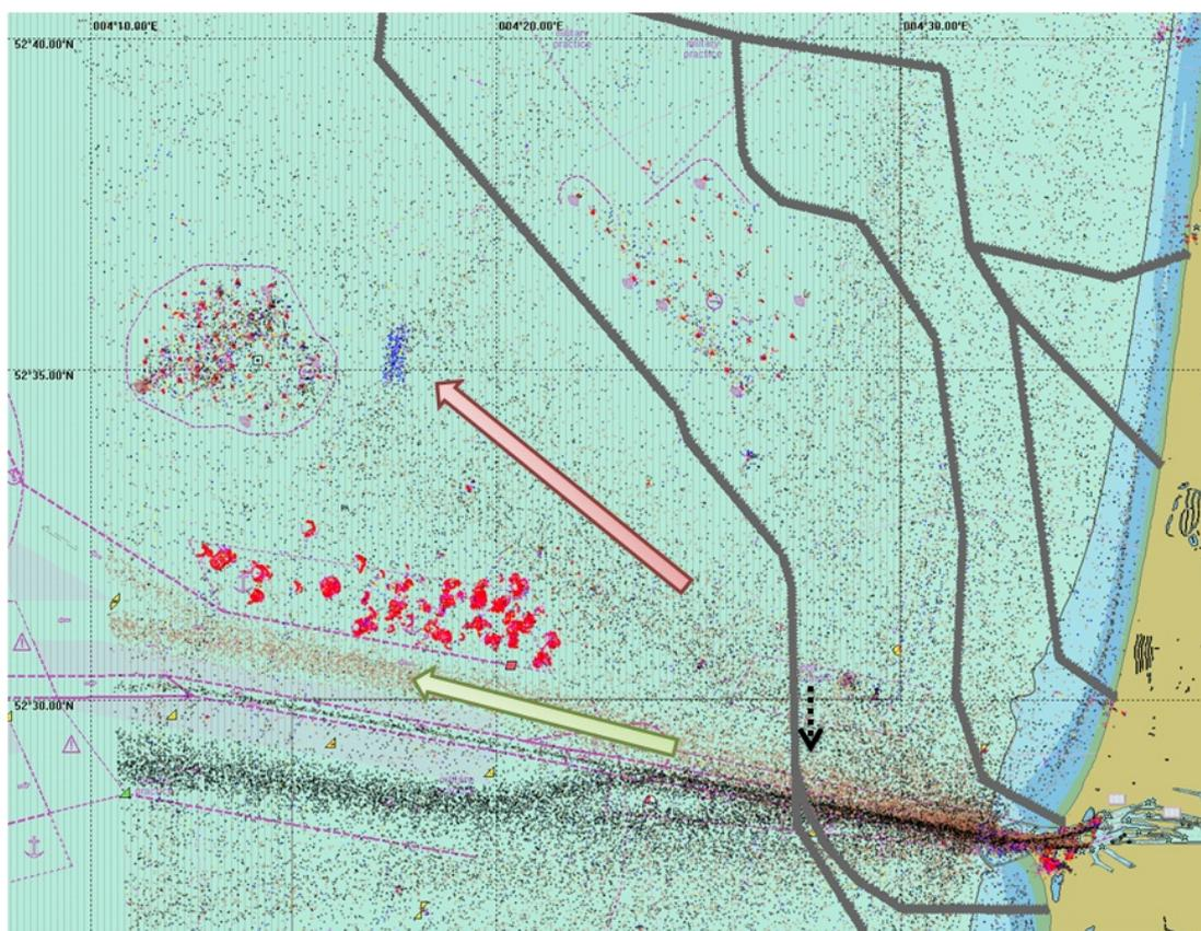
Figuur 4-8 Verschuiving van verkeersstromen door de aanleg van het windpark Hollandse Kust (noord).
