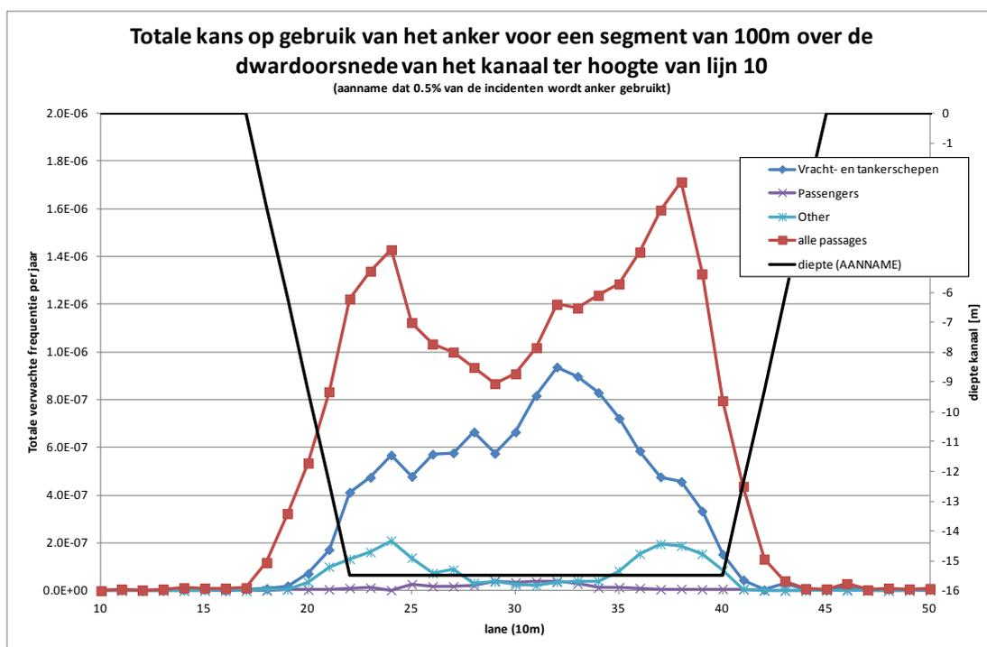
**Figuur 5-11** Totale kans op gebruik van het anker per vak van 10m x 100m per jaar ter hoogte van lijn 10.
