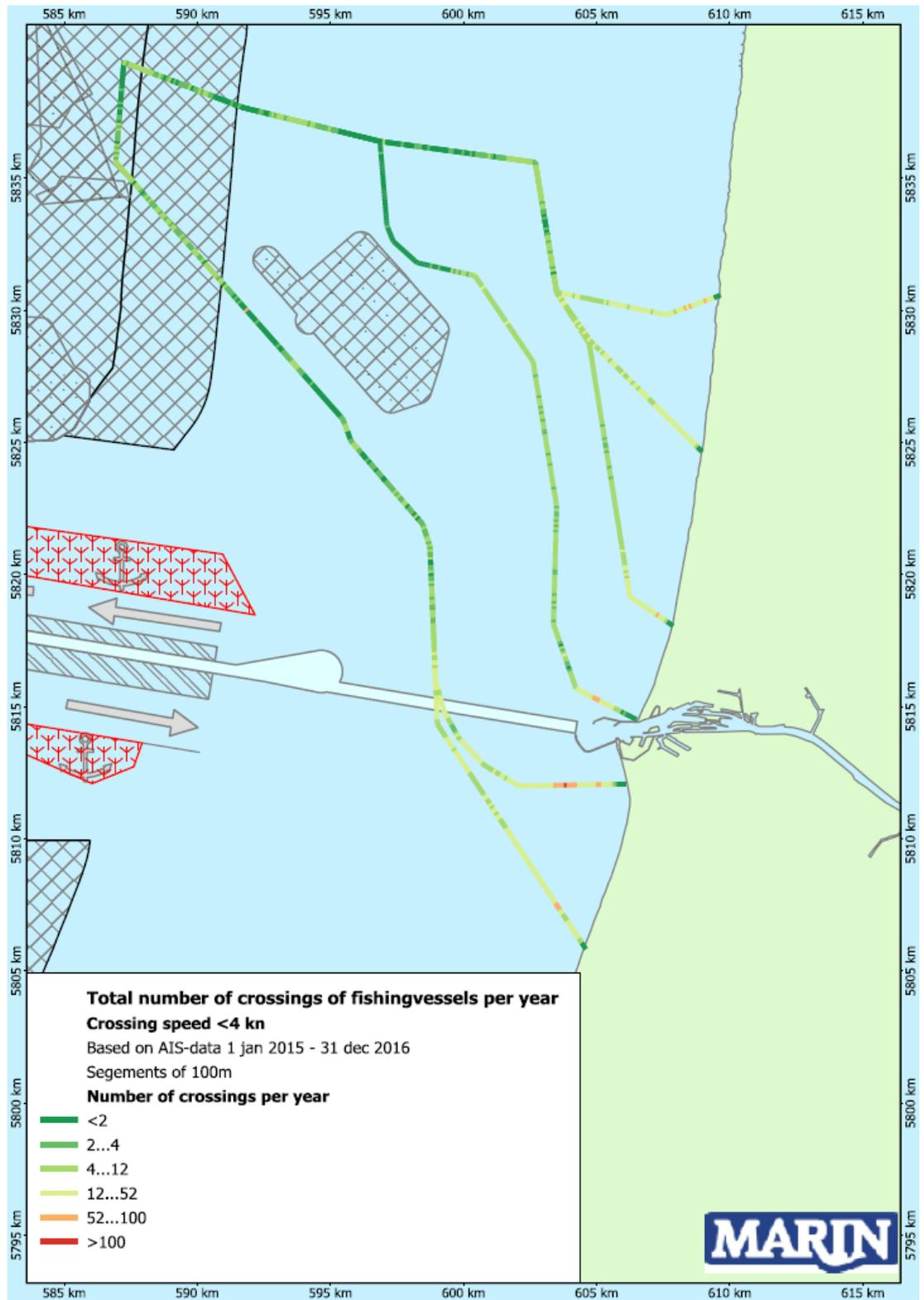
Figuur 4-5 Aantal passages per jaar door vissersvaartuigen met snelheid lager dan 4 kn (gebaseerd op AIS-data 1 jan 2015 - 31 dec 2016)
